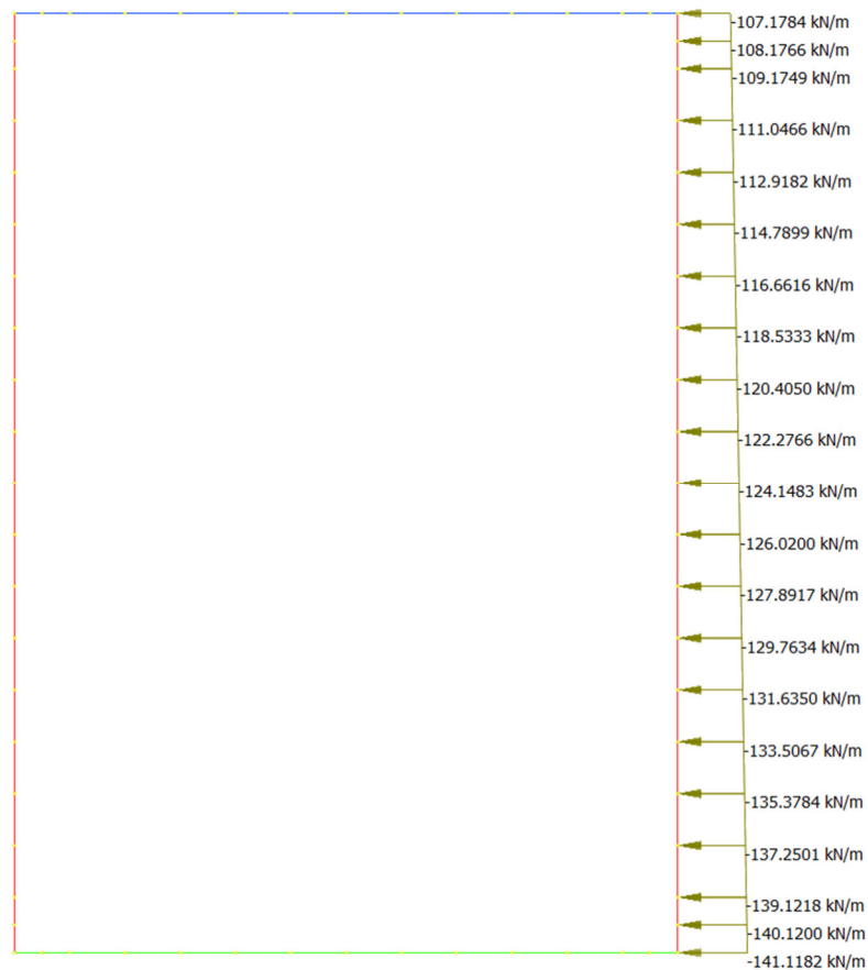
Figure 8-4: Spinta statica del terreno DX
