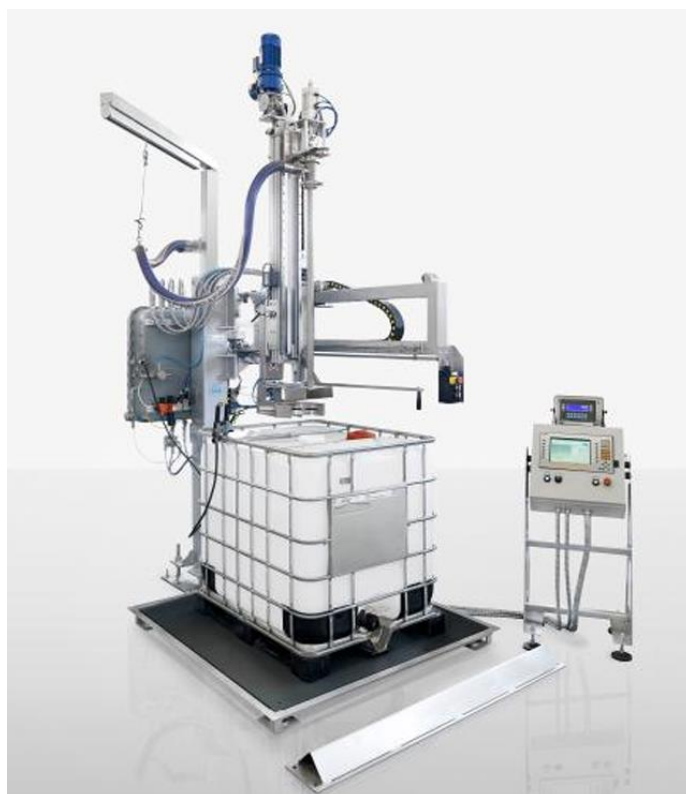
Figura 39 – Macchina confezionatrice semi-automatica per il prodotto finale (immagine dimostrativa)
