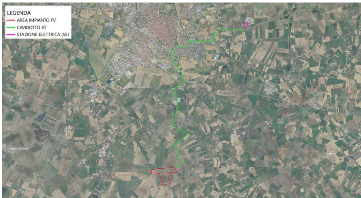
Figura 5-12: inquadramento del cavidotto di connessione a 36kV
