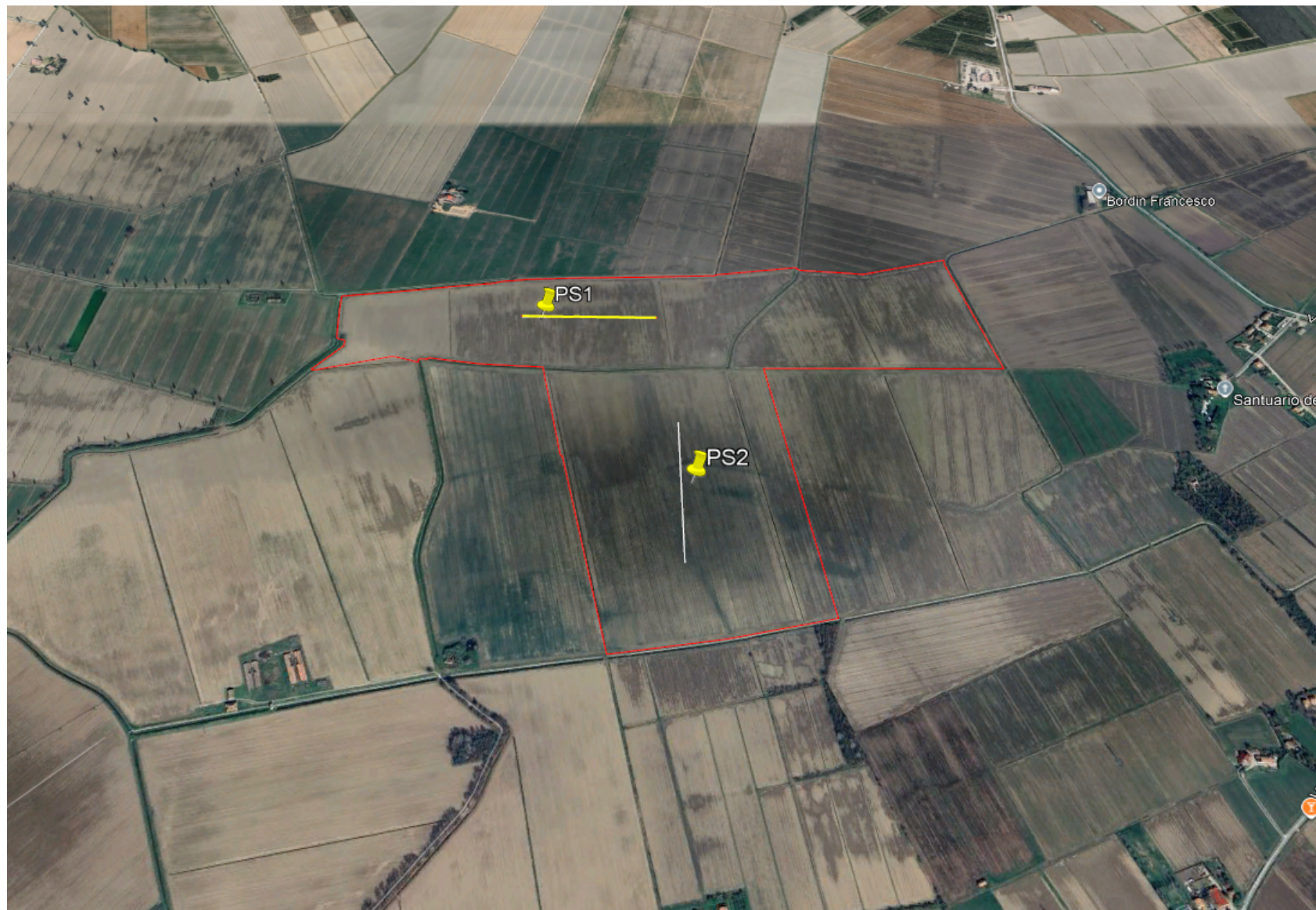
LOCALIZZAZIONE SU STRALCIO ORTOFOTO SATELLITARE DELLE TRACCE DEI PROFILI SISMICI ESEGUITI
