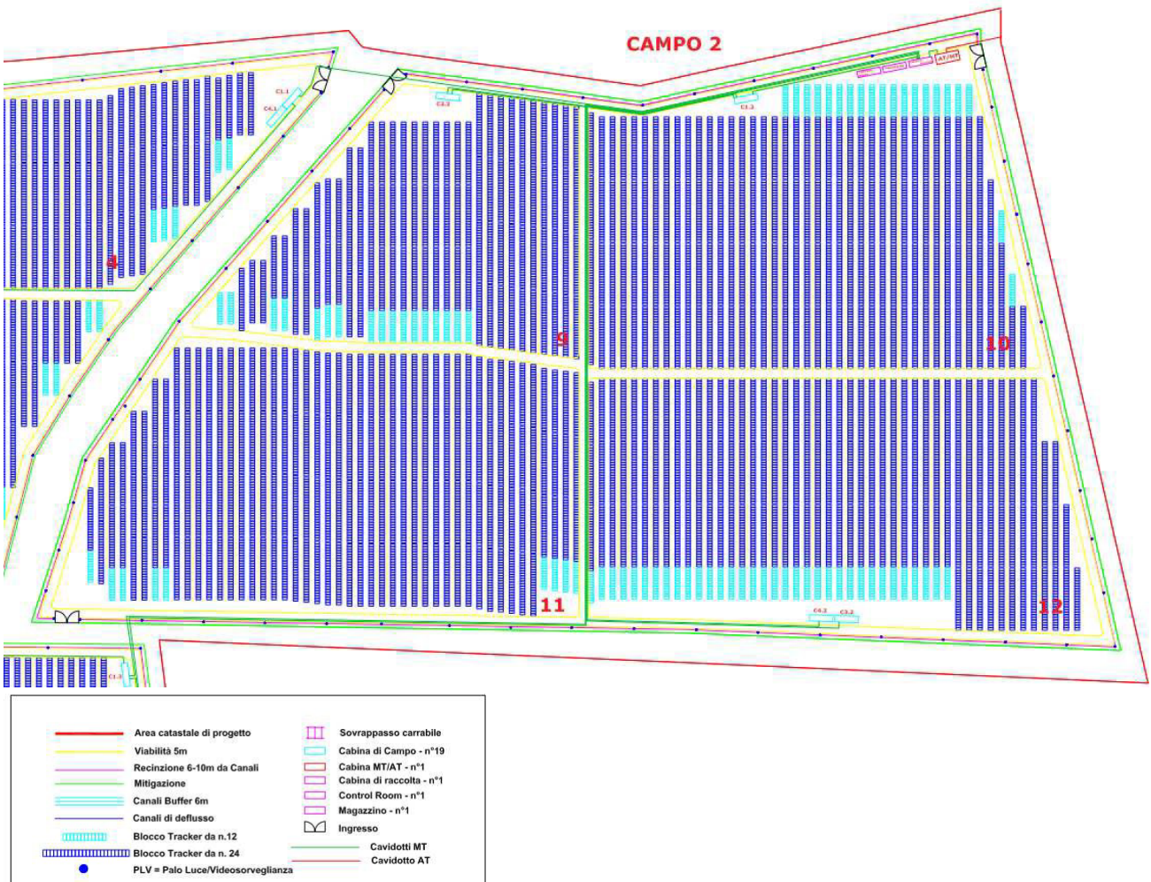
Figura 19 Individuazione cavidotti MT per il campo 2
