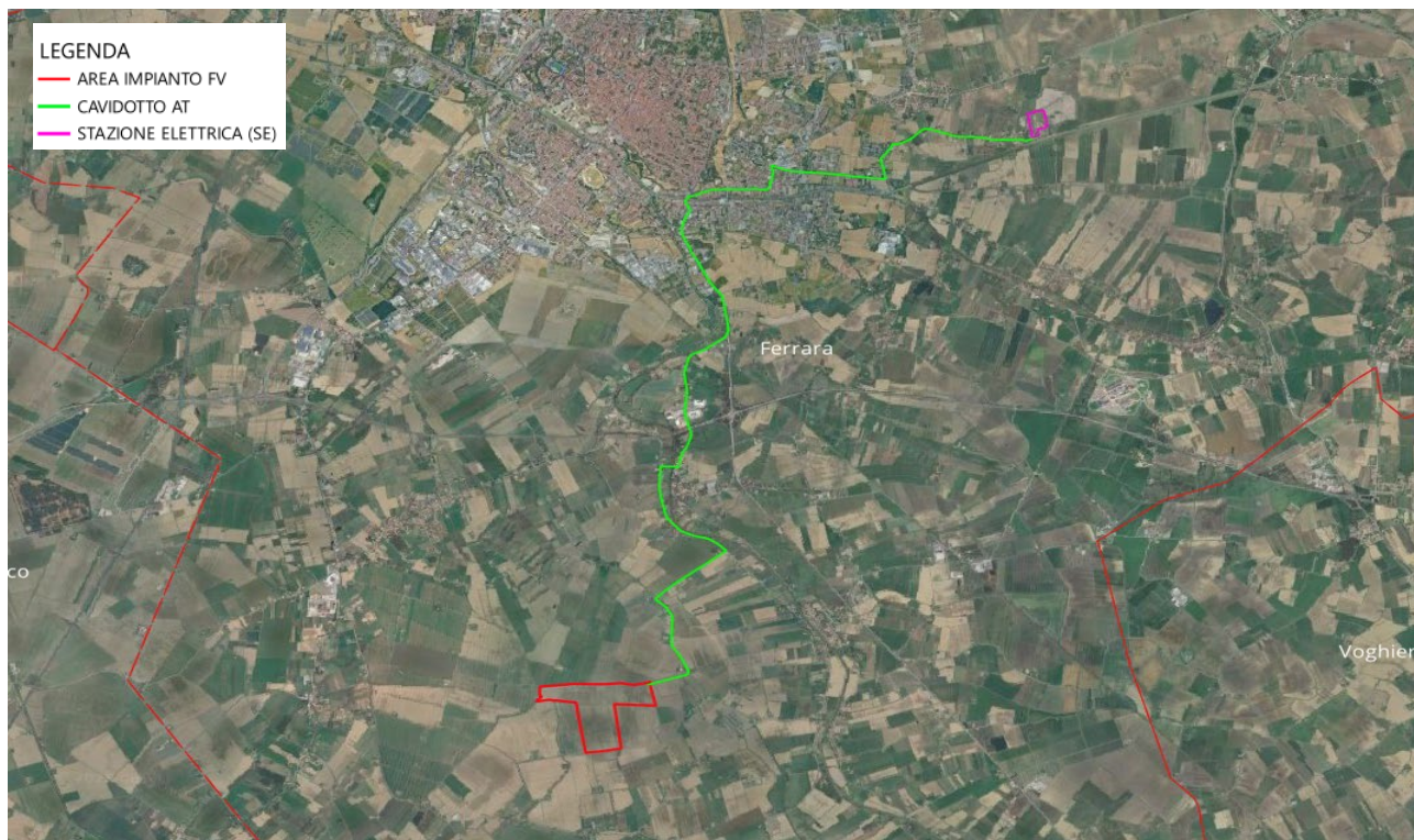
Figura 4-1: inquadramento del cavidotto di connessione a 36kV
