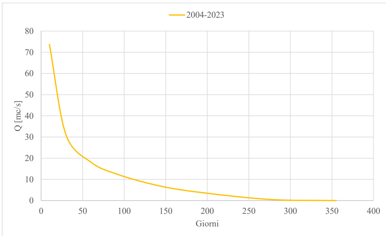
Figura 24: Curva di durata delle portate (periodo di analisi: 2004-2023) - Sorbolo.
