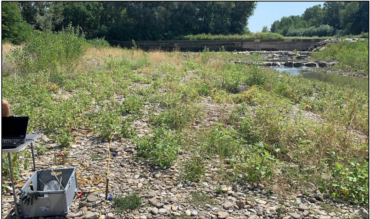
Figura 1: Vista dello stendimento MASW effettuato.
