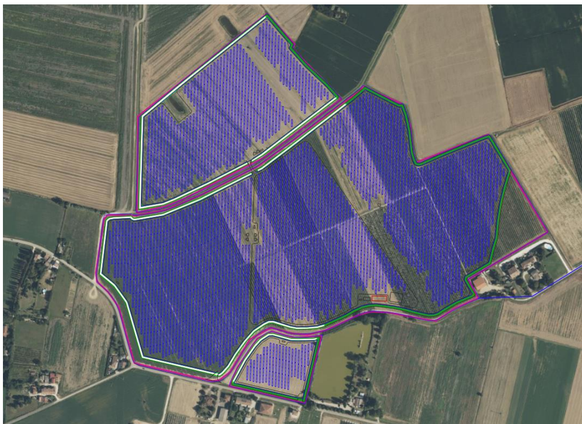
Figura 34 - Layout dell'impianto, con evidenziate le fasce di mitigazione (verde chiaro la normale e verde scuro la rafforzata), l'area investita a agrivoltaico avanzato e le aree di servizio.
