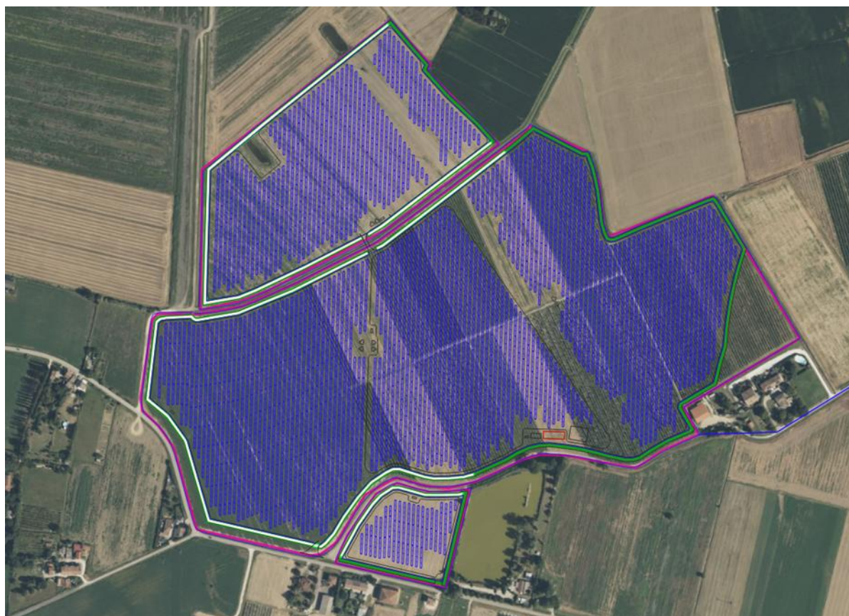
Figura 17 - Layout dell'impianto, con evidenziate le fasce di mitigazione (verde chiaro la normale e verde scuro la rafforzata), l'area investita ad agrivoltaico avanzato e le aree di servizio.
