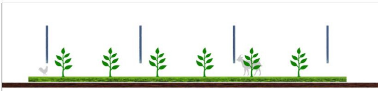
Figura 7: Sistema agrivoltaico in cui i moduli fotovoltaici sono disposti verticalmente. La coltivazione avviene tra le file dei moduli fotovoltaici, l'altezza minima dei moduli da terra influenza il possibile passaggio di animali (TIPO 3).
