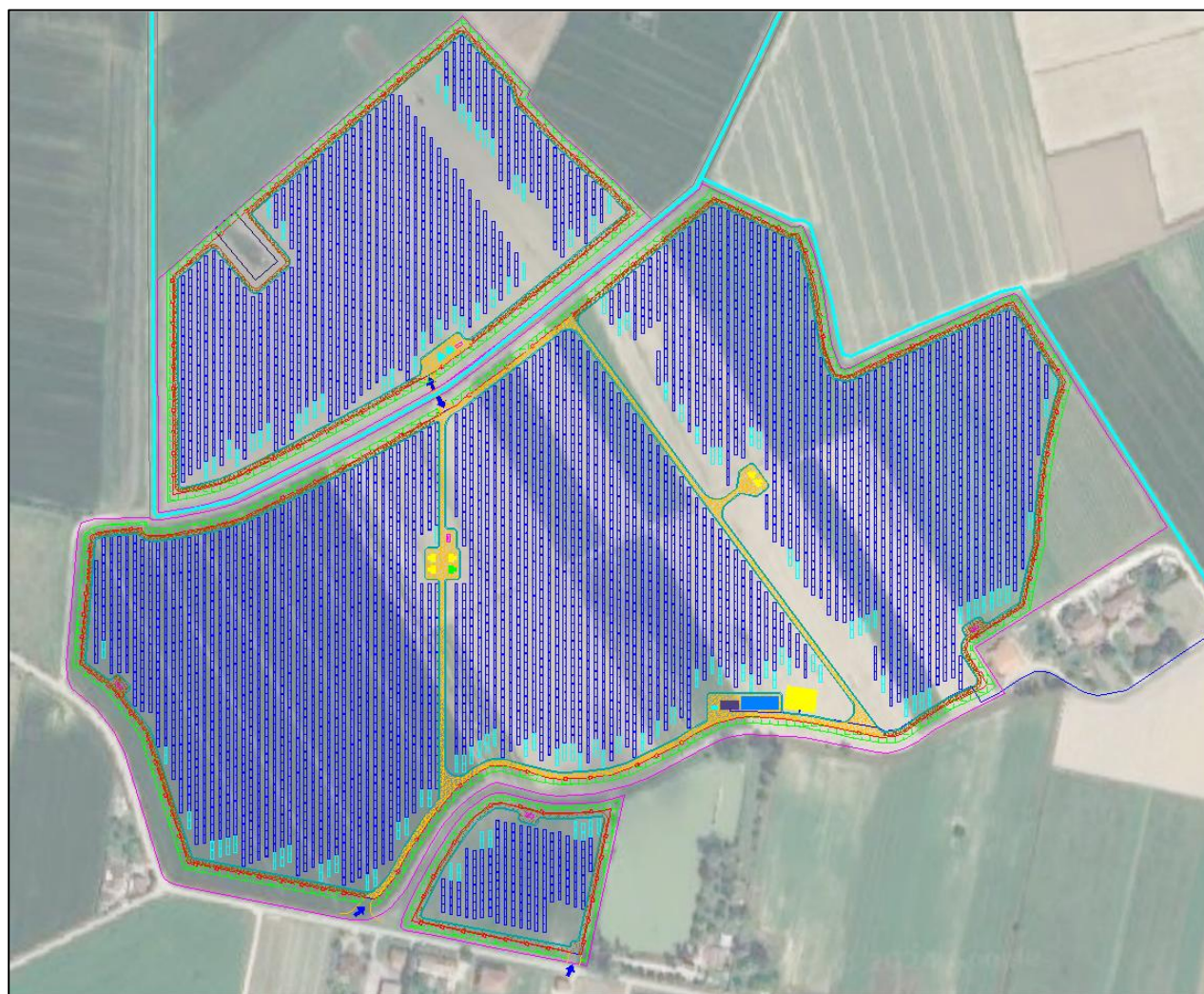
Figura 25: Inquadramento su ortofoto del layout di impianto e dei canali esistenti in ciano
