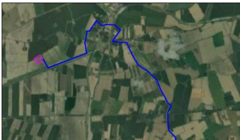
Figura 1 - Inquadramento su base ortofoto delle opere in progetto. In rosso l'area di impianto; in ciano l'area lorda di progetto; in blu il cavidotto 36 kV; in magenta la futura SE Terna.
