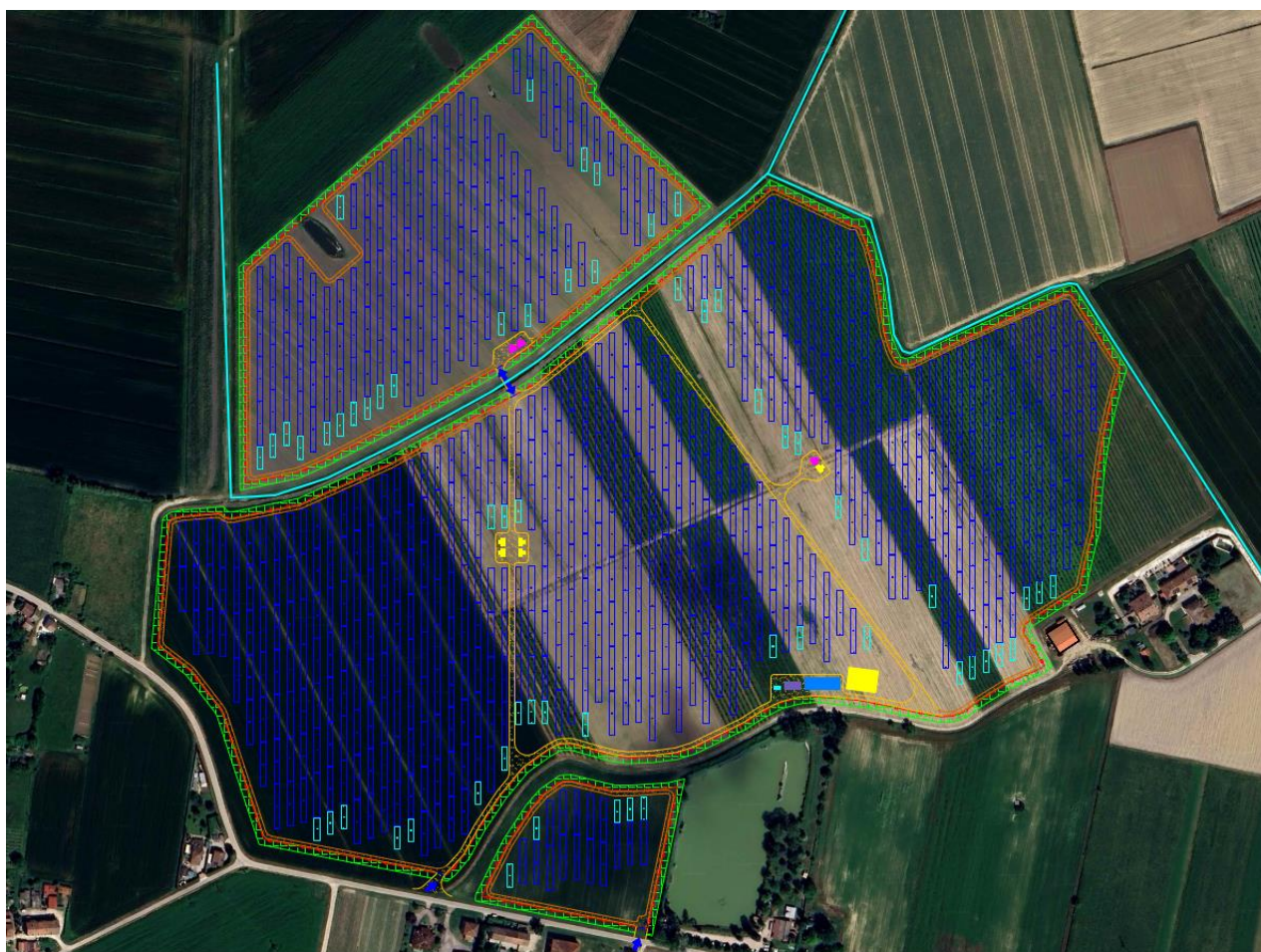
Figura 6: Inquadramento su ortofoto del layout di impianto e dei canali esistenti in viola
