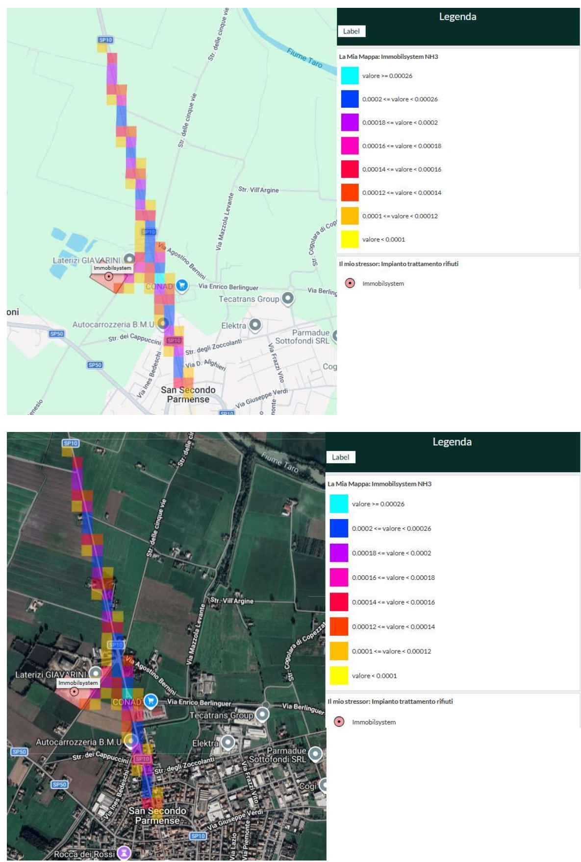
Figura 41 : Concentrazioni di \text{NH}_3 [ \mu\text{g}/\text{m}^3 ] – Focus rispetto all’intera area di simulazione (Quadrato di lato 6000 m centrato in “Immobilsystem”)
