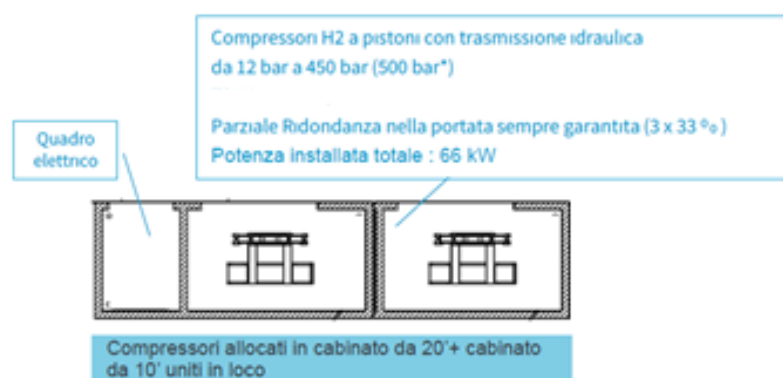
Figura 92. Configurazione tipica del container "compressione"(immagine esemplificativa)
