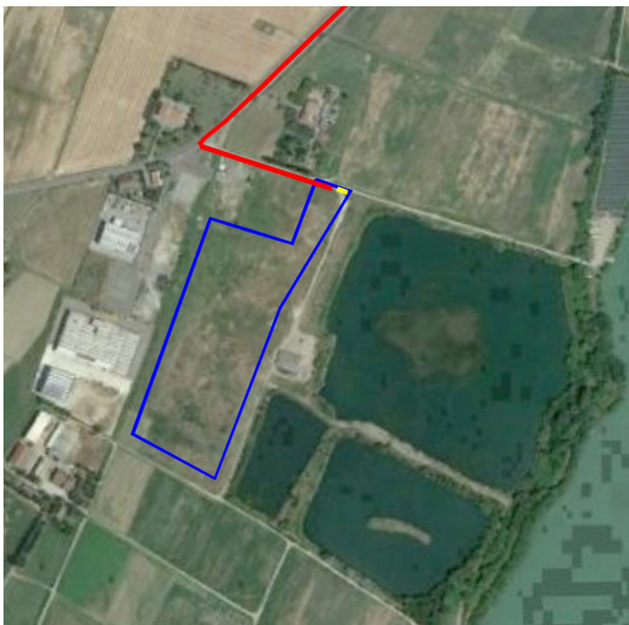
Figura 8.3.1 – Ipotesi della soluzione tecnica minima fornita da E-Distribuzione a seguito richiesta preventivo per STMG (fuori scala). In giallo la cabina di consegna dell'impianto.
