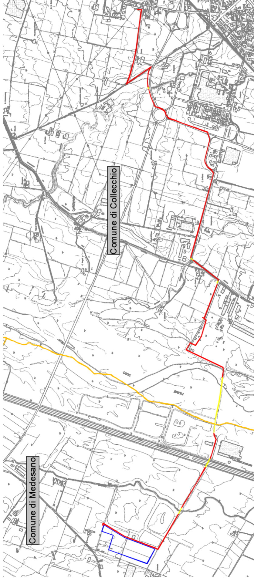
Figura 2.1.1 - Inquadramento dell'area di intervento su CTR. In blu l'area in cui si prevede la realizzazione dell'impianto fotovoltaico, in rosso il tracciato della linea elettrica di connessione interrato, in giallo i tratti realizzati in TOC.
