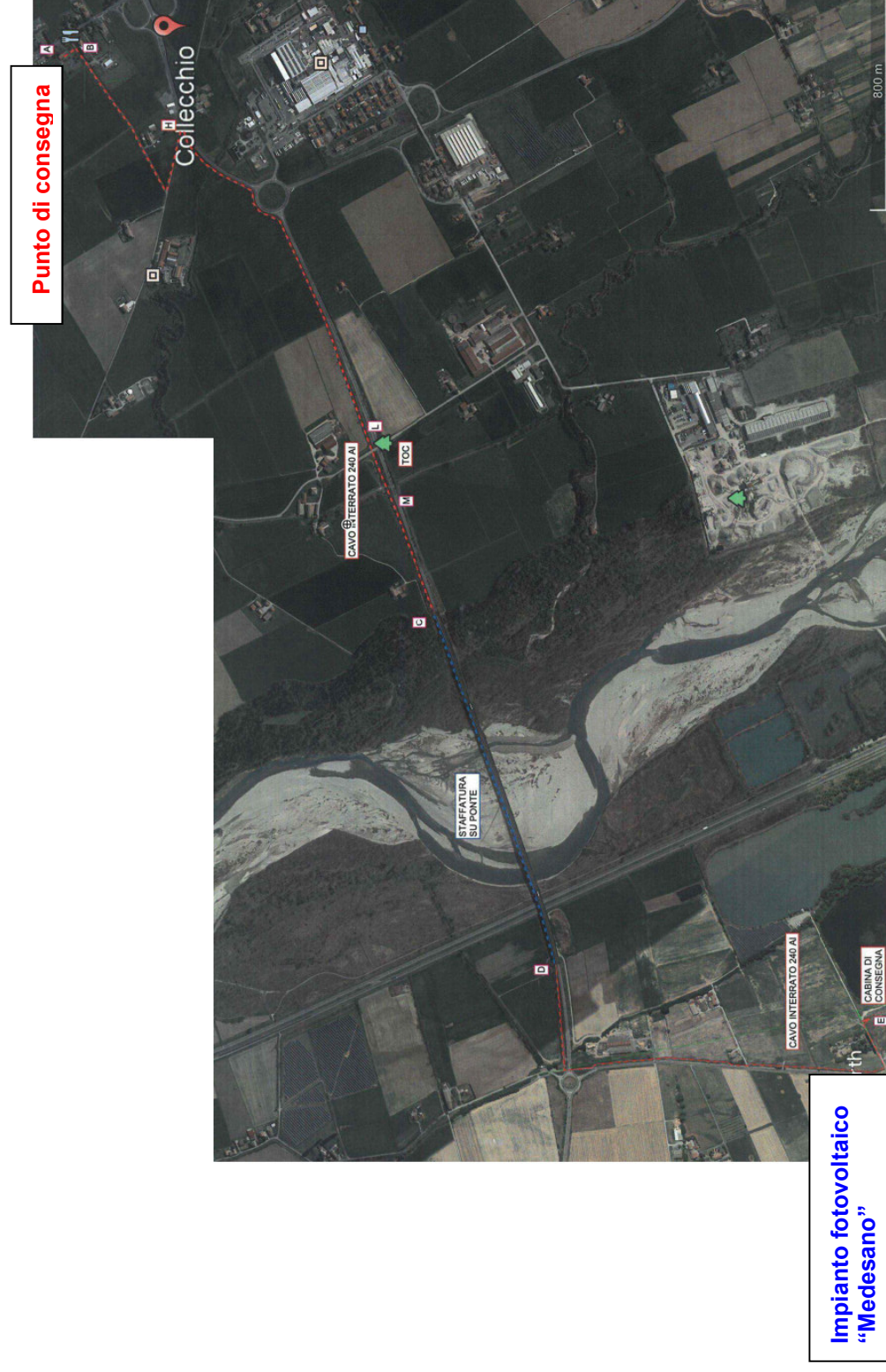
Figura 8.3.3 – Foto aerea con evidenziate la definitiva alternativa di connessione dell'impianto fotovoltaico alla cabina di consegna prevista da E-Distribuzione per l'attraversamento del F. Taro con cavo agganciato alla struttura del ponte stradale esistente.
