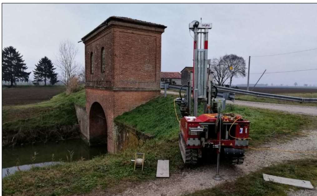
Figura 8.2. Esecuzione prova CPTU 1
