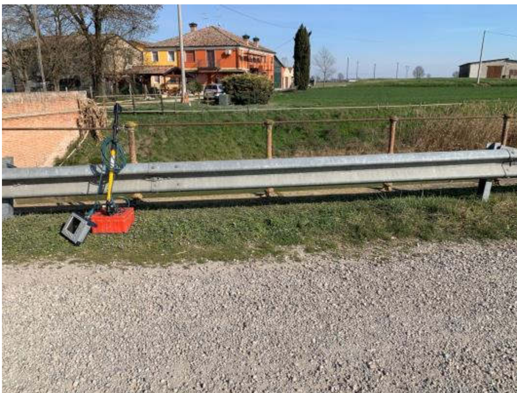
Indagine con antenna da 400Mhz da estradosso ponte
