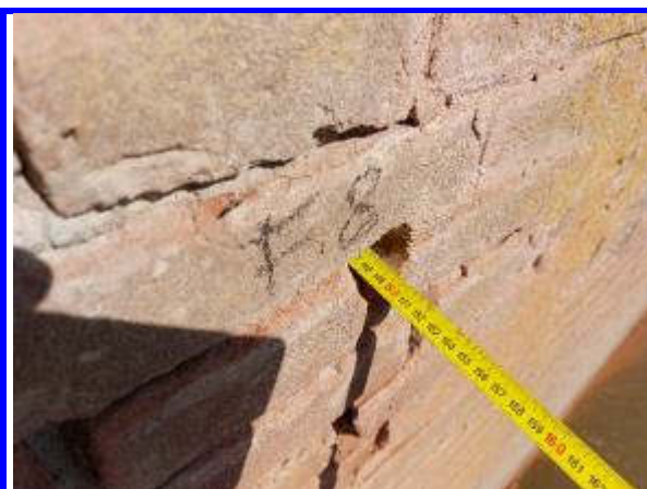
Foro F8 per determinazione spessore muratura
