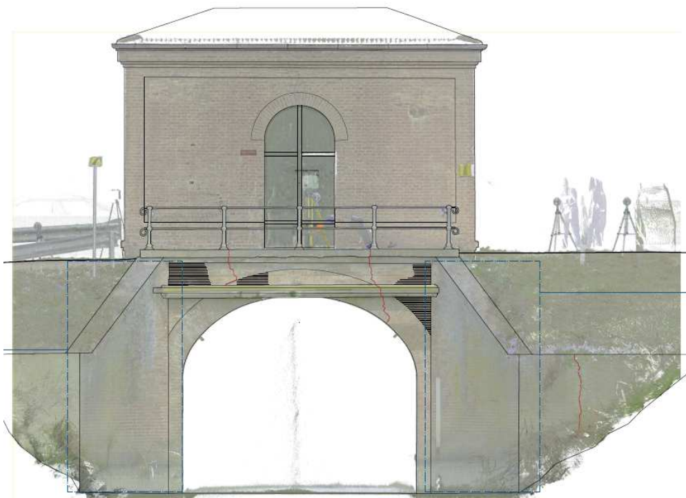
Figura 12 Estratto dalle tavole grafiche dello stato di fatto. Fronte sud della chiavica della "Cucca".
