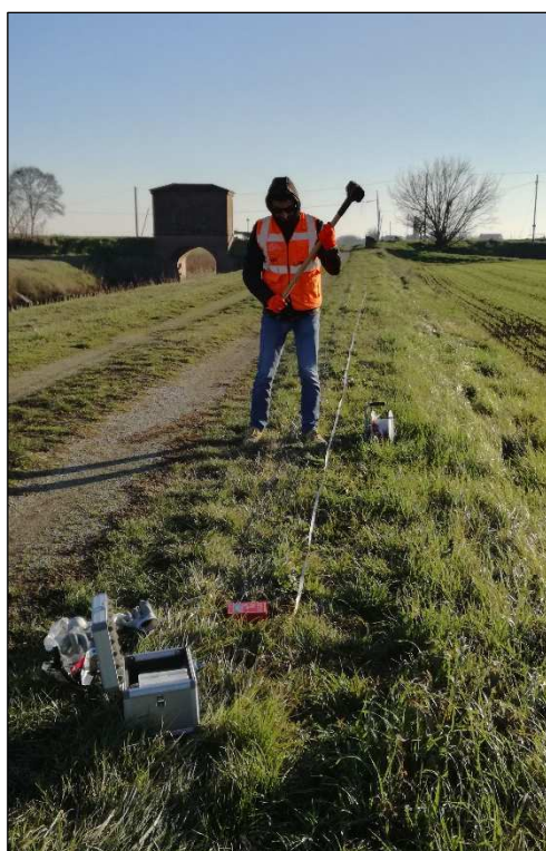
Figura 8.3. Esecuzione prove sismiche: MASW 1 (sinistra) e HVSR 1 (destra)
