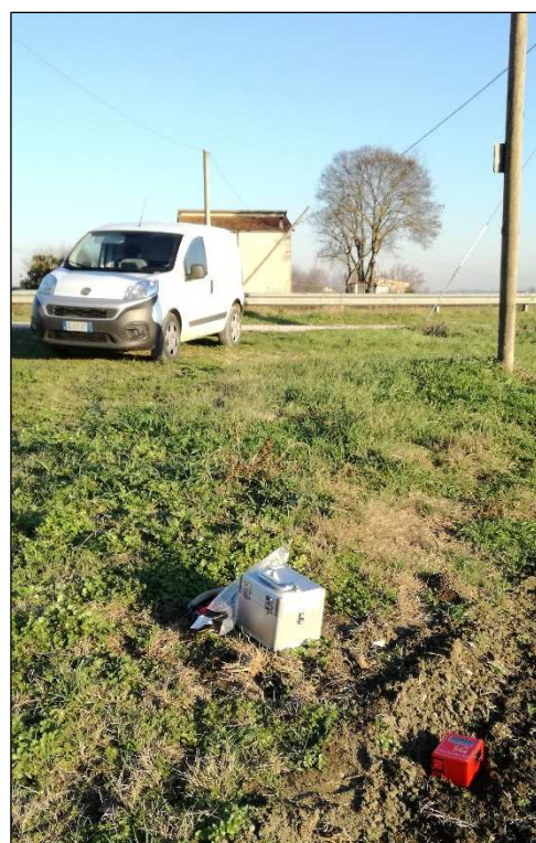
Figura 8.3. Esecuzione prove sismiche: MASW 1 (sinistra) e HVSR 1 (destra)
