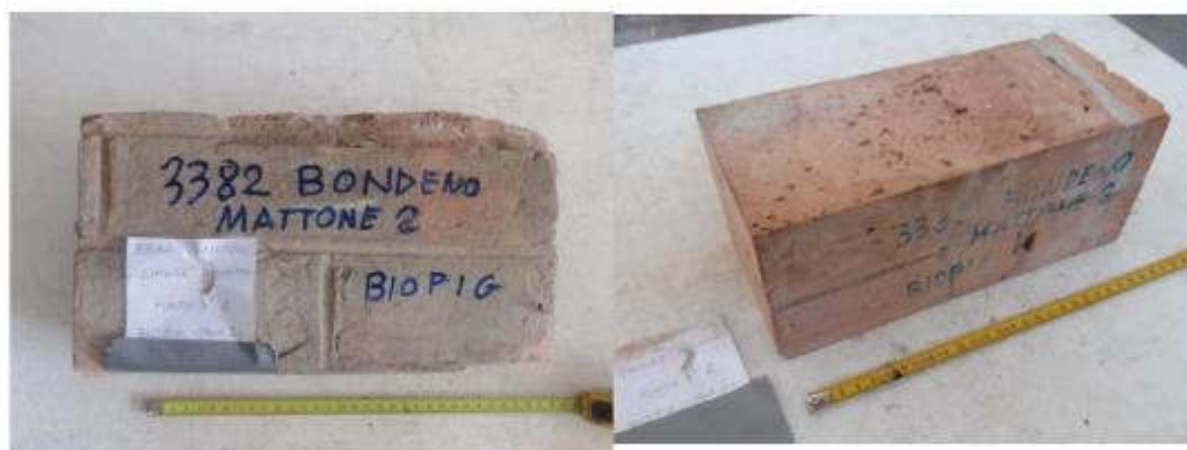
Blocco n.2 come consegnato e dopo rettifica per compressione
