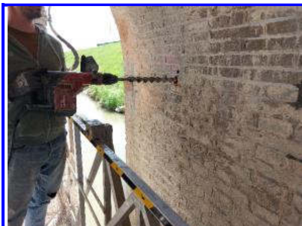
Foro F7 per determinazione spessore muratura
