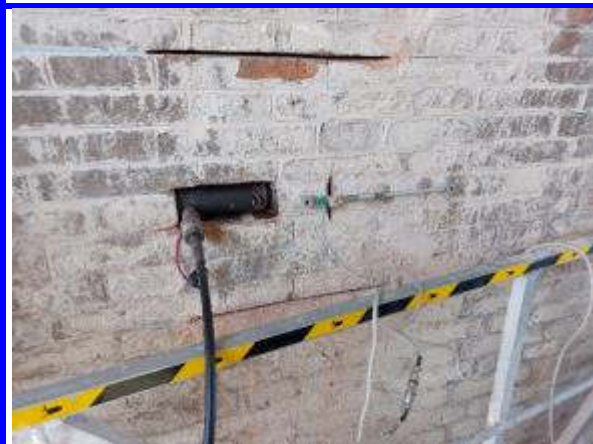
Prova a taglio su muratura
