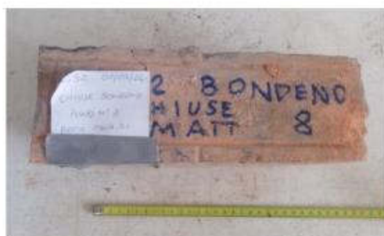
Blocco n.7 come consegnato e dopo retifica per compressione
