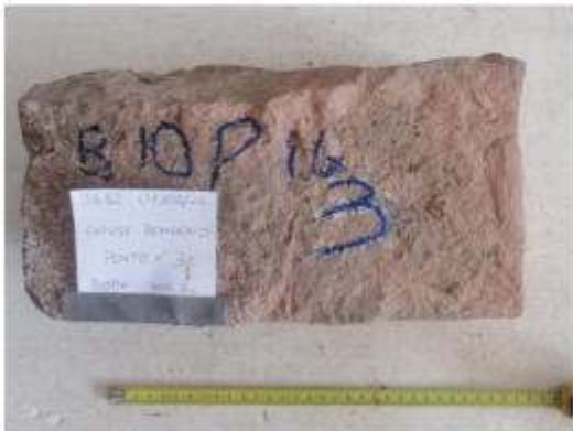
Blocco n.3 come consegnato e dopo rettifica per compressione
