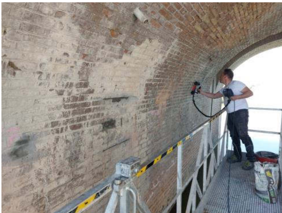
Indagine con antenna da 1500Mhz da intradosso ponte
