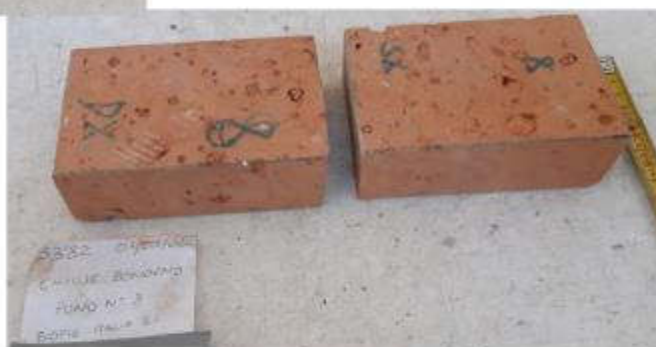
Blocco n.8 come consegnato e dopo retifica per compressione
