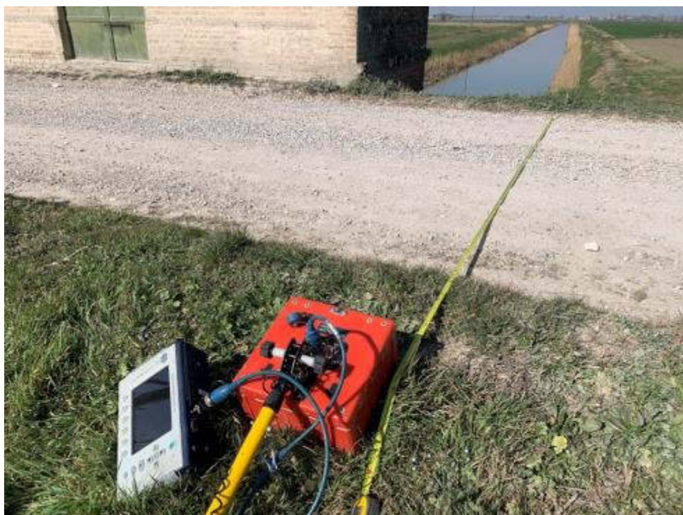
Indagine con antenna da 400Mhz da estradosso ponte
