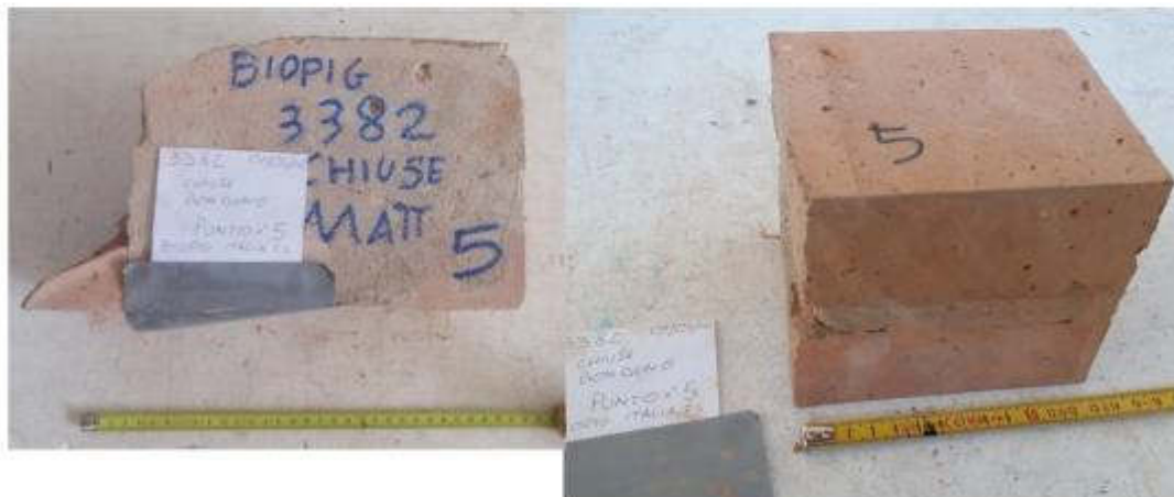
Blocco n.5 come consegnato e dopo rettifica per compressione
