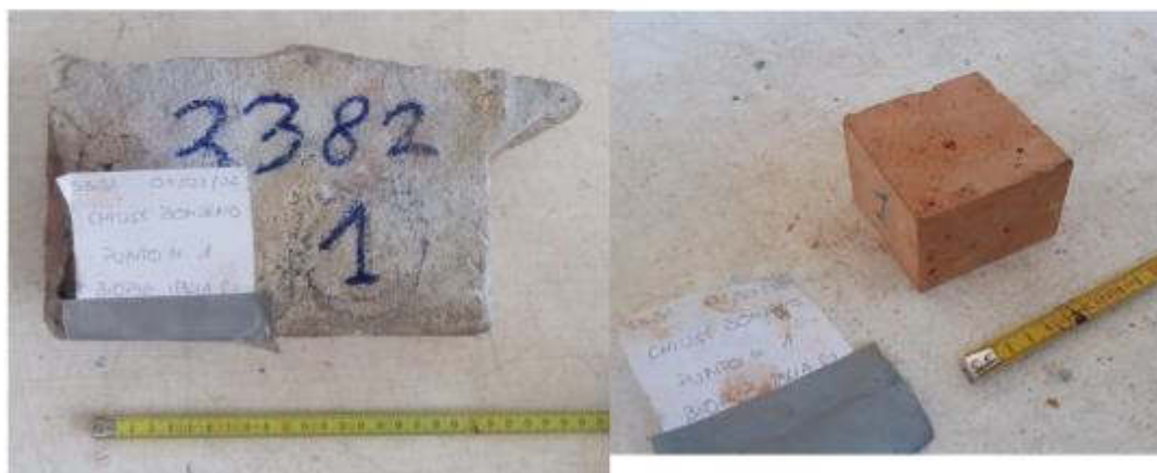
Blocco n.2 come consegnato e dopo rettifica per compressione
