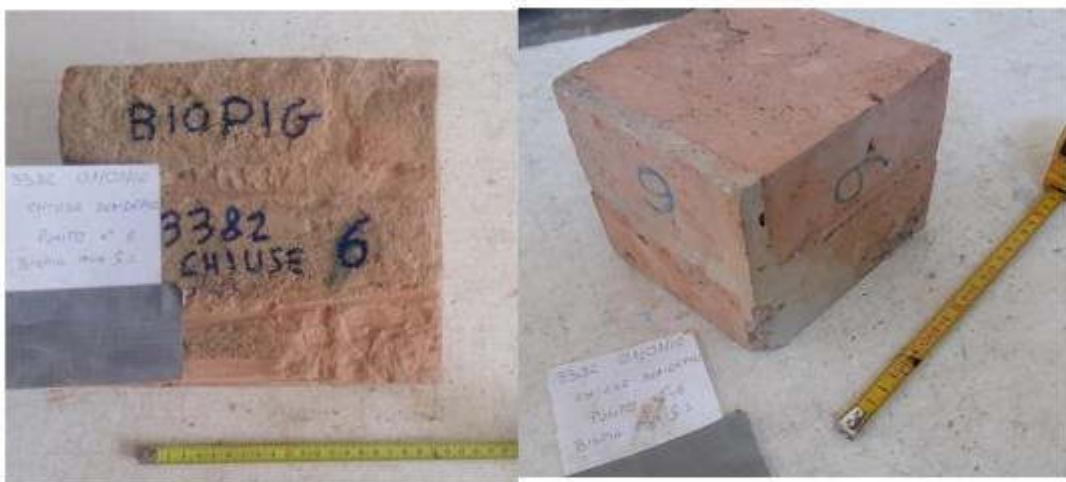
Blocco n.6 come consegnato e dopo rettifica per compressione
