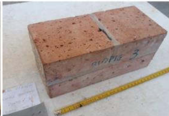
Blocco n.3 come consegnato e dopo rettifica per compressione
