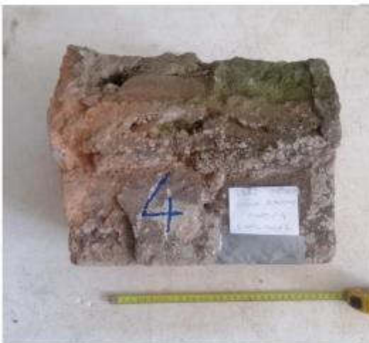
Blocco n.4 come consegnato e dopo rettifica per compressione
