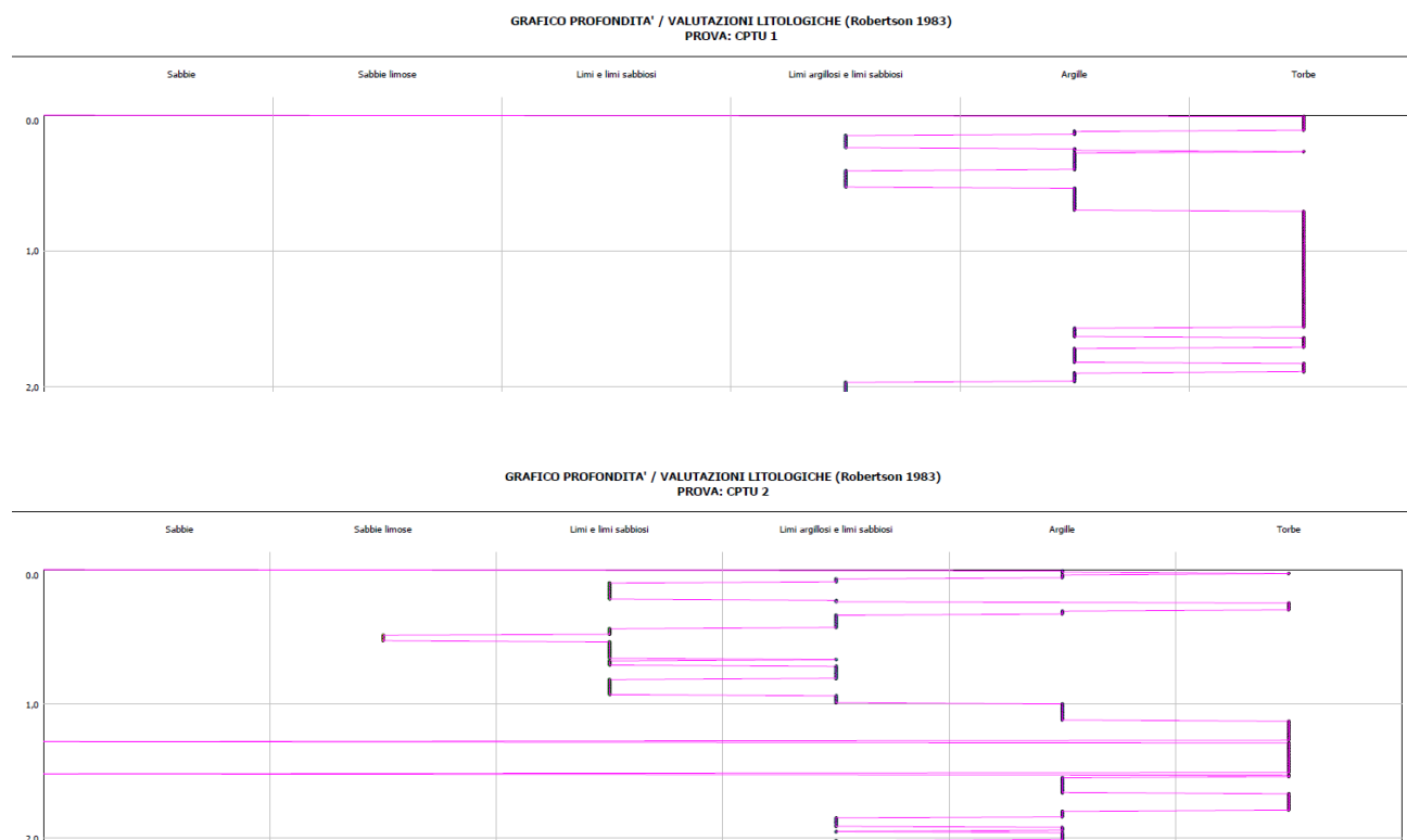
Figura 4.2. Litologia di dettaglio di CPTU 1 (in alto) e di CPTU 2 (in basso).
