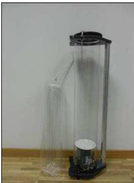
Campionatore passivo e contenitore in nalophan
