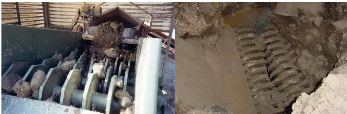
Figura 5.1 – Esempio di griglia a dischi (sinistra) e di tritratore a dischi (destra).
