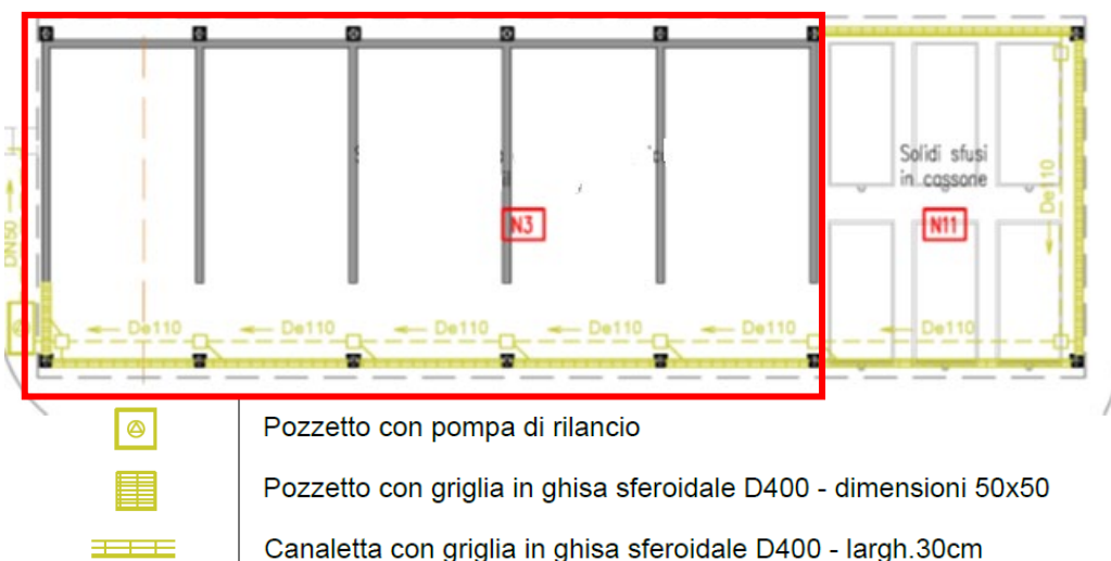
Figura 15 – Dettaglio rete di drenaggio sezione N3 ed N11 (stralcio elaborato CO 05 RA AA 01 DT PL 03.02 – Allegato 3B – Planimetria dell'impianto (rete idrica))
