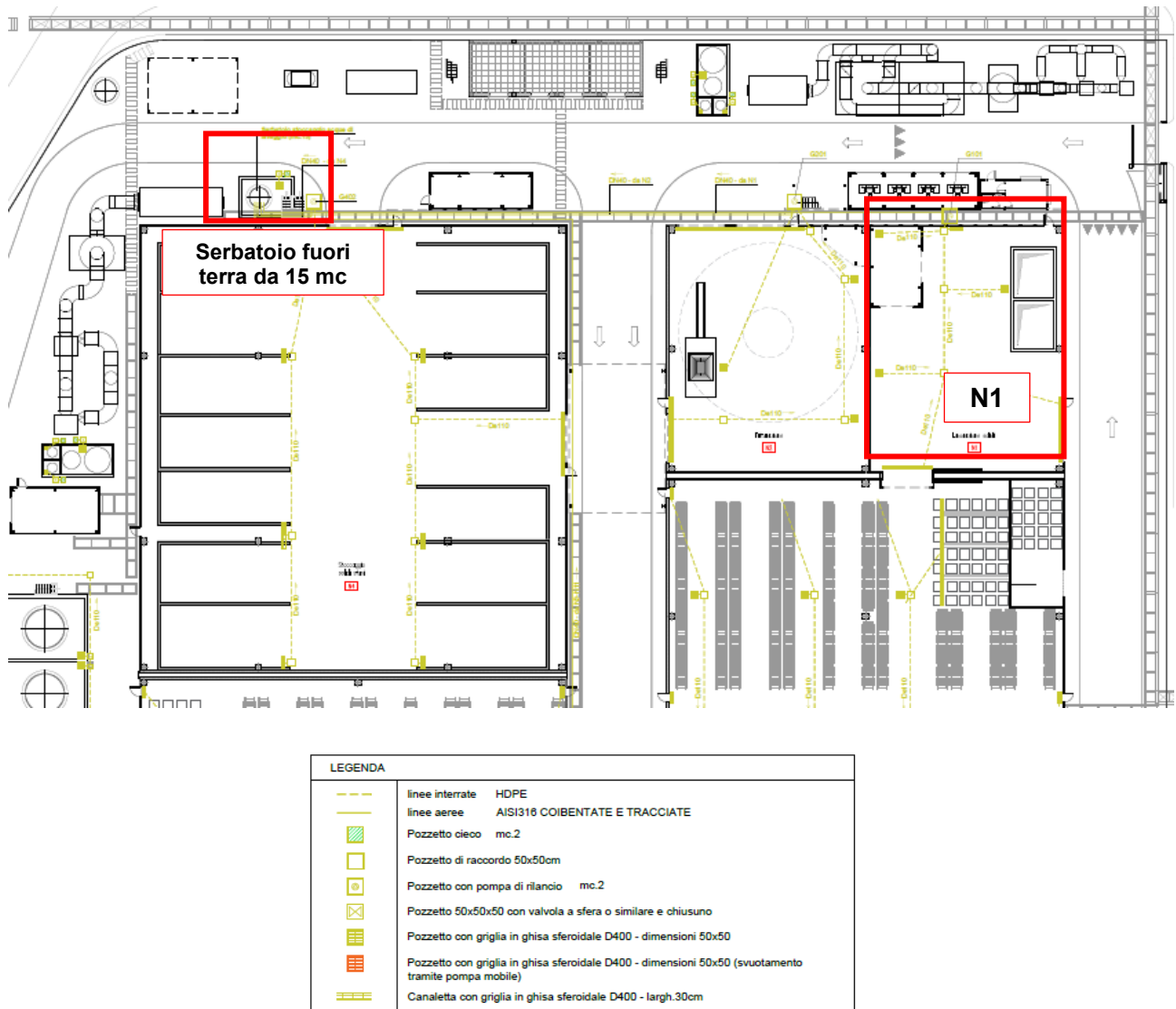
Figura 7 - Dettaglio rete di drenaggio sezione N1 e serbatoio di raccolta fuori terra (stralcio elaborato CO 05 RA AA 01 DT PL 03.02 – Allegato 3B – Planimetria dell'impianto (rete idrica))
