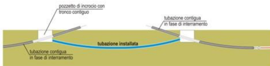
5 - Messa in Opera pozzetti
