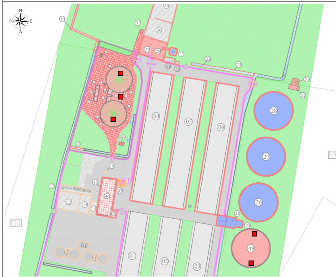
Fig. 13. Estratto dalla planimetria di progetto con indicazione ( in rosso ) dei punti d'indagine proposti.
