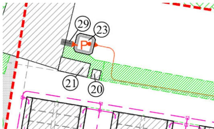
All'uscita del separatore il chiarificato confluisce in una vasca di accumulo, coperta, equipaggiata con una pompa di rilancio, che ha la funzione di trasferire il refluo allo stoccaggio finale. La vasca presenta un volume di 109.35 mc.
