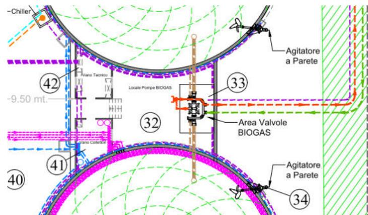
Lungo il lato ovest della sala comandi sono ricavati un vano tecnico dove sono alloggiati i quadri elettrici e i comandi che governano il funzionamento dell'impianto; un secondo vano tecnico contiene i collettori per la distribuzione dell'acqua, sia calda che fredda, alle diverse utenze.
