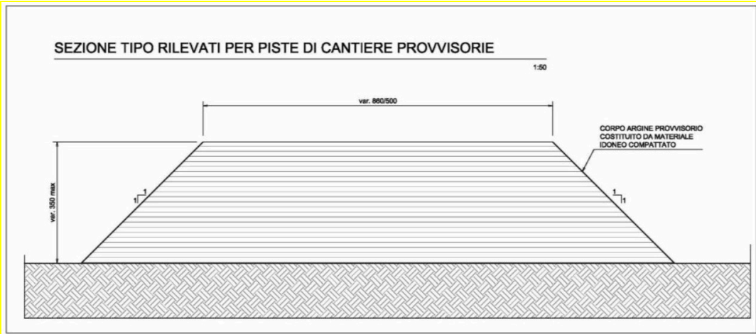
Sezione tipo rilevati per piste di cantiere provvisorie
