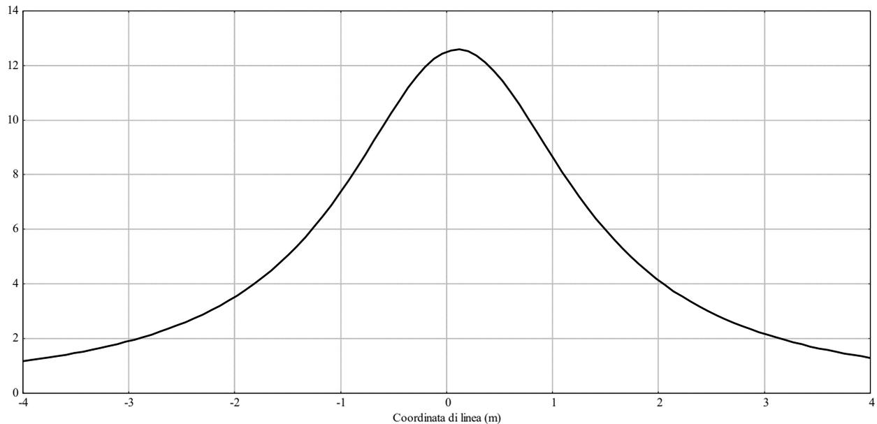
Si denota, come in corrispondenza dell'asse del cavidotto (x: 0,10 m), il valore si attesta attorno a 13 µT, per poi decrescere simmetricamente su ambo i lati, rimanendo sotto il valore di 3 µT nella fascia compresa da -2,4 e 2,6 m rispetto ad asse terna di cavi (ampiezza fascia DPA 5 metri).
