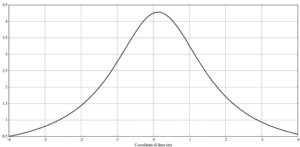
Si denota, come in corrispondenza dell'asse del cavidotto (x: 0,10 m), il valore si attesta attorno a 4,3  $\mu$ T, per poi decrescere simmetricamente su ambo i lati, rimanendo sopra il valore di 3  $\mu$ T nella fascia compresa da -0,9 e 1,1 m rispetto ad asse terna di cavi (ampiezza fascia DPA 2 m).
