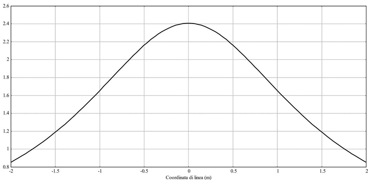
Si denota, come in corrispondenza dell'asse del cavidotto (x: 0 m), il valore si attesta attorno a 2,4  $\mu\text{T}$ , per poi decrescere simmetricamente su ambo i lati, comunque sempre inferiore al valore di soglia posto pari a 3  $\mu\text{T}$ .
