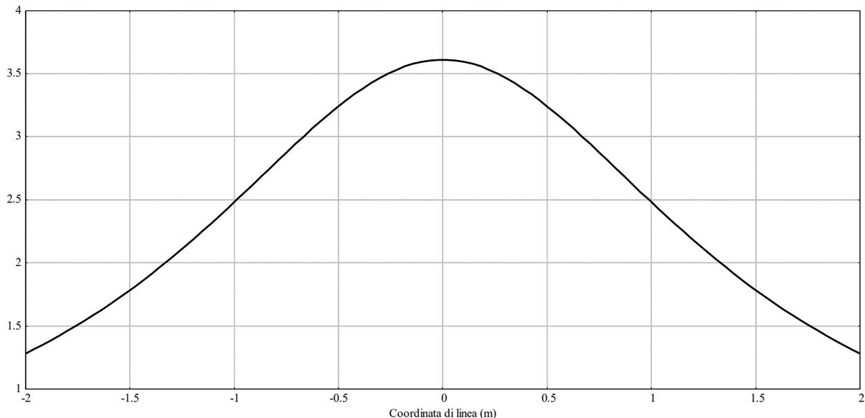
Si denota, come in corrispondenza dell'asse del cavidotto (x: 0 m), il valore si attesta attorno a 3,6  $\mu\text{T}$ , per poi decrescere simmetricamente su ambo i lati, rimanendo sotto il valore di 3  $\mu\text{T}$  nella fascia compresa da -0,7 e 0,7 m rispetto ad asse terna di cavi (ampiezza fascia DPA 1,4 metri).
