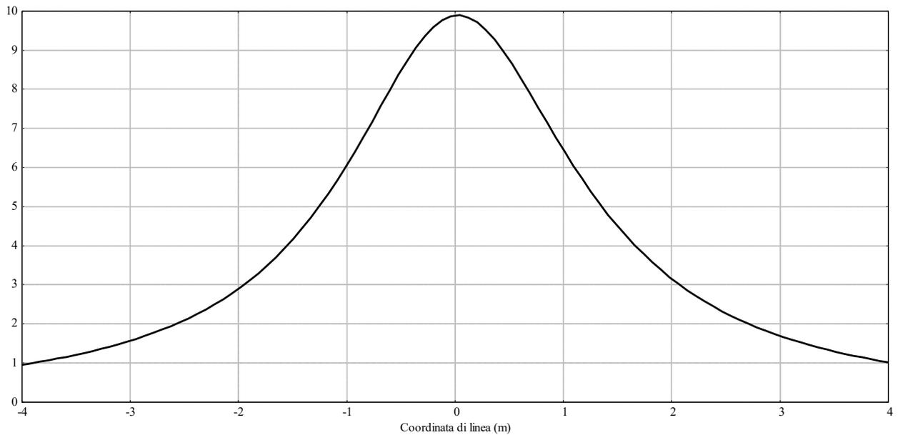
Si denota, come in corrispondenza dell'asse del cavidotto (x: 0,10 m), il valore si attesta attorno a 10  $\mu\text{T}$ , per poi decrescere simmetricamente su ambo i lati, rimanendo sotto il valore di 3  $\mu\text{T}$  nella fascia compresa da -1,9 e 2,1 m rispetto ad asse terna di cavi (ampiezza fascia DPA 4 metri).
