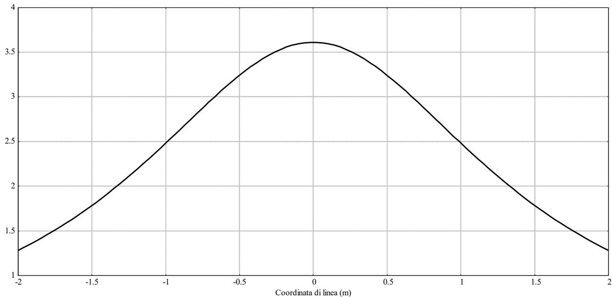
Si denota, come in corrispondenza dell'asse del cavidotto (x: 0 m), il valore si attesta attorno a 3,6  $\mu\text{T}$ , per poi decrescere simmetricamente su ambo i lati, rimanendo sotto il valore di 3  $\mu\text{T}$  nella fascia compresa da -0,7 e 0,7 m rispetto ad asse terna di cavi (ampiezza fascia DPA 1,4 metri).
