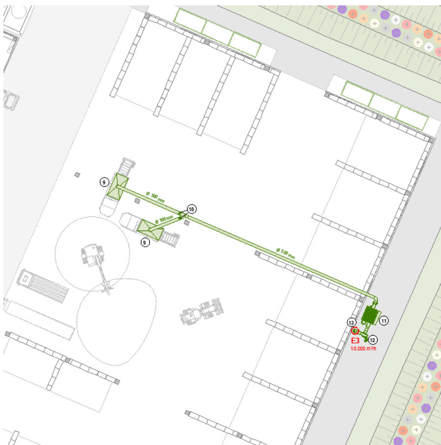
Fig.26. - Planimetria rete aspirazione Nuovo Fabbricato [4] – Stato di progetto
