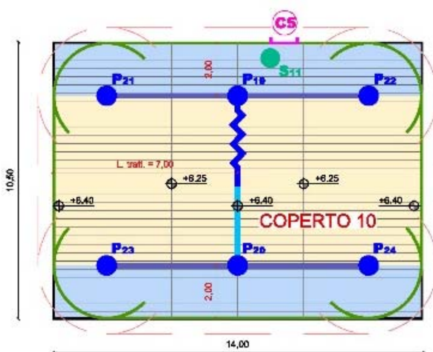
Fig.8: Sistemi di sicurezza COPERTO 10
