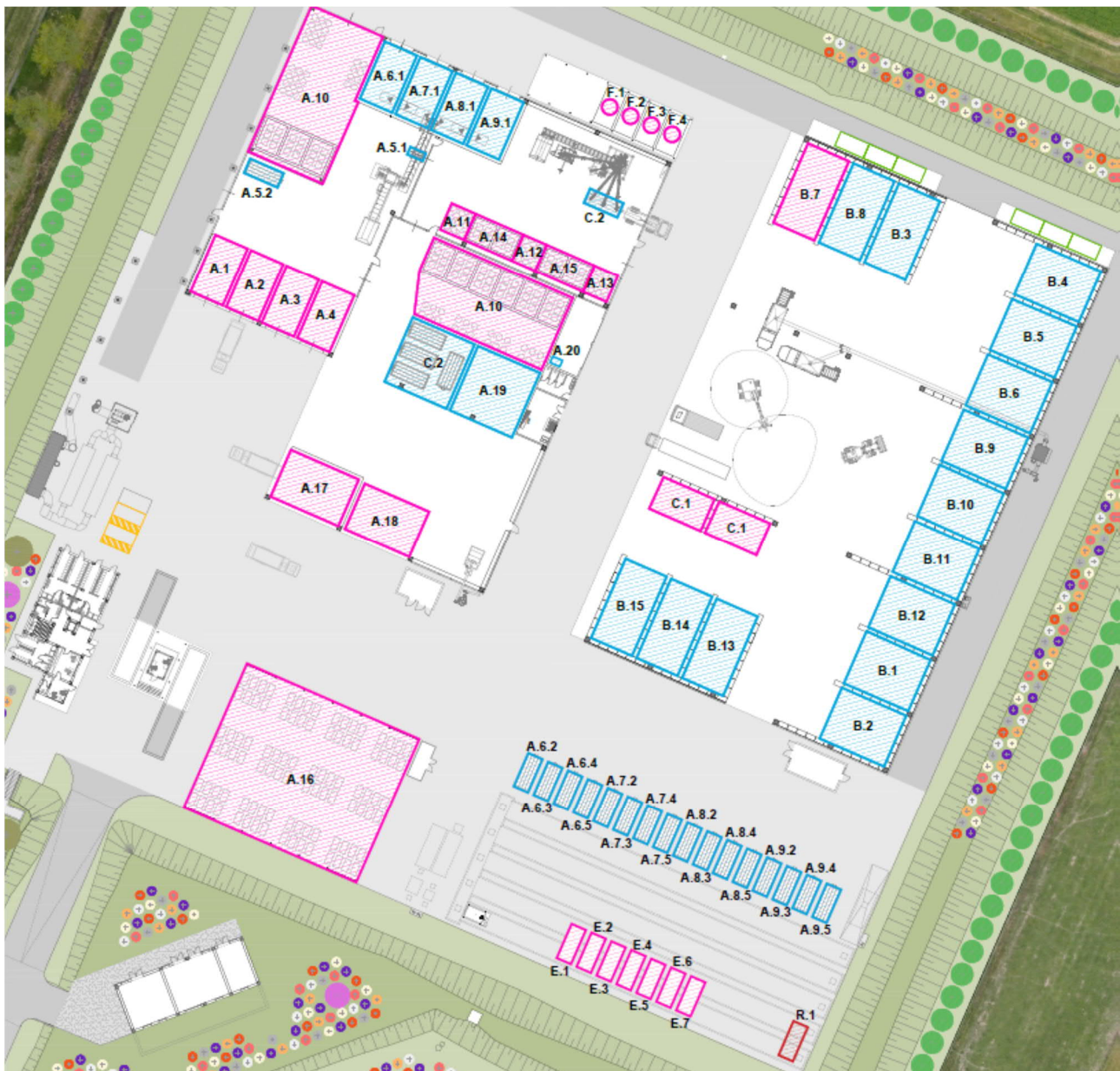
Fig.3 - Layout stoccaggi in progetto
