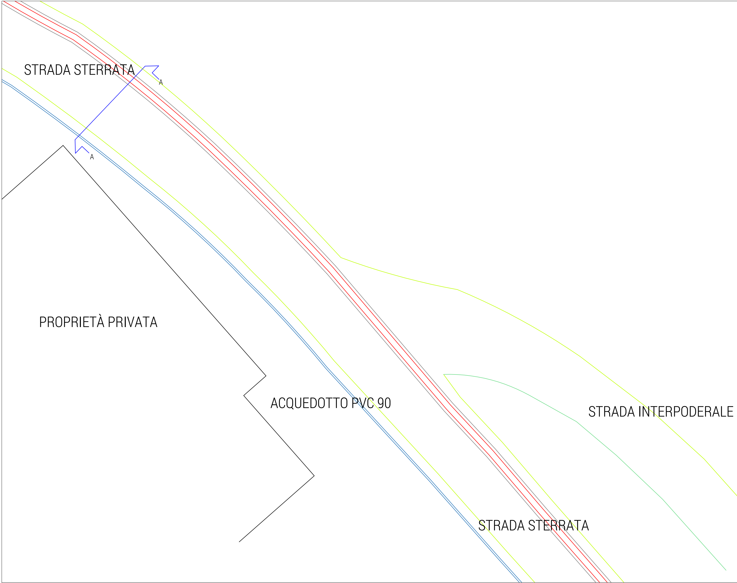
SEZIONE A-A: Posizionamento Linea MT -rispetto all'acquedotto - Scala 1:10
