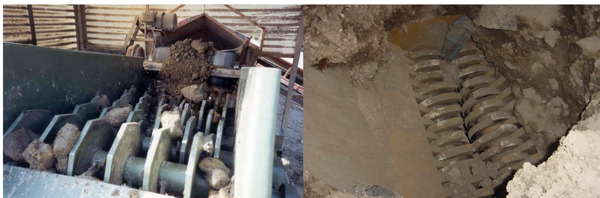
Figura 5 - Esempio di griglia a dischi (sinistra) e di tritratore a dischi (destra).
