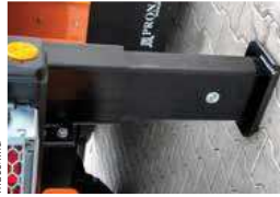
Staffa di sostegno idraulica garantisce la stabilità della macchina
