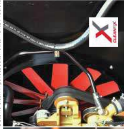
Sistema Cleanfix pulisce automaticamente il radiatore del motore e dell'olio idraulico
