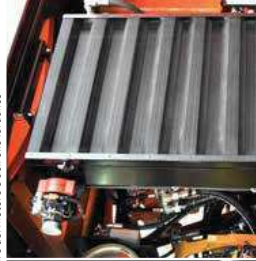
Sistema Cleanfix pulisce automaticamente il radiatore del motore e dell'olio idraulico
