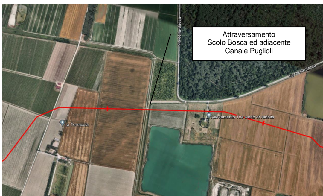
Figura 2.3: Stralcio con foto aerea dell'ubicazione dell'attraversamento dello Scolo Bosca e adiacente Canale Puglioli con il metanodotto in progetto (in rosso)
