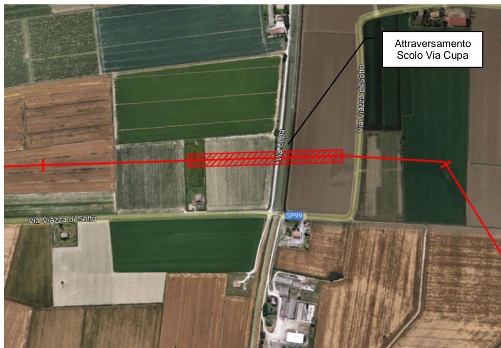
Figura 2.3: Stralcio con foto aerea dell'ubicazione dell'attraversamento dello Scolo Via Cupa con il metanodotto in progetto (in rosso)
