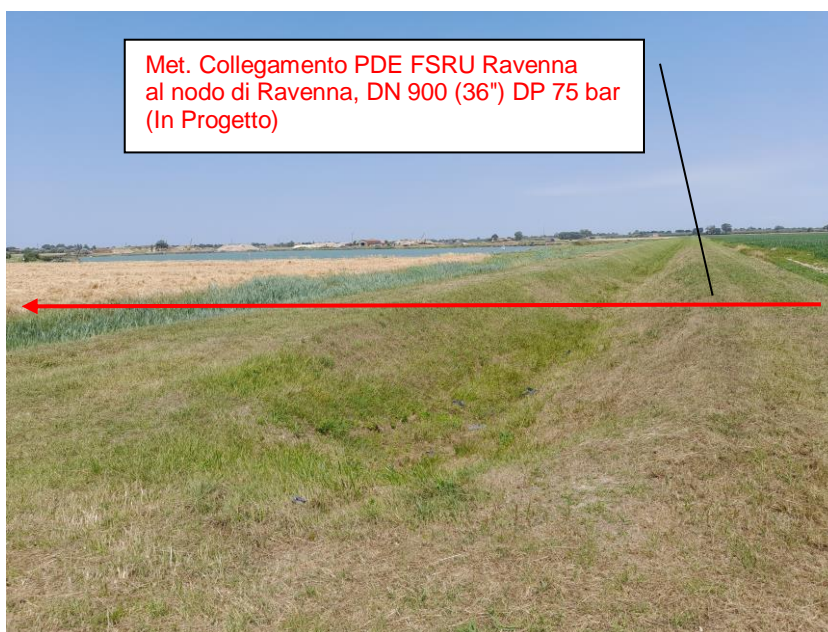
Figura 3.2: Attraversamento Scollo Bosca (in rosso l'andamento qualitativo della tubazione in progetto)
