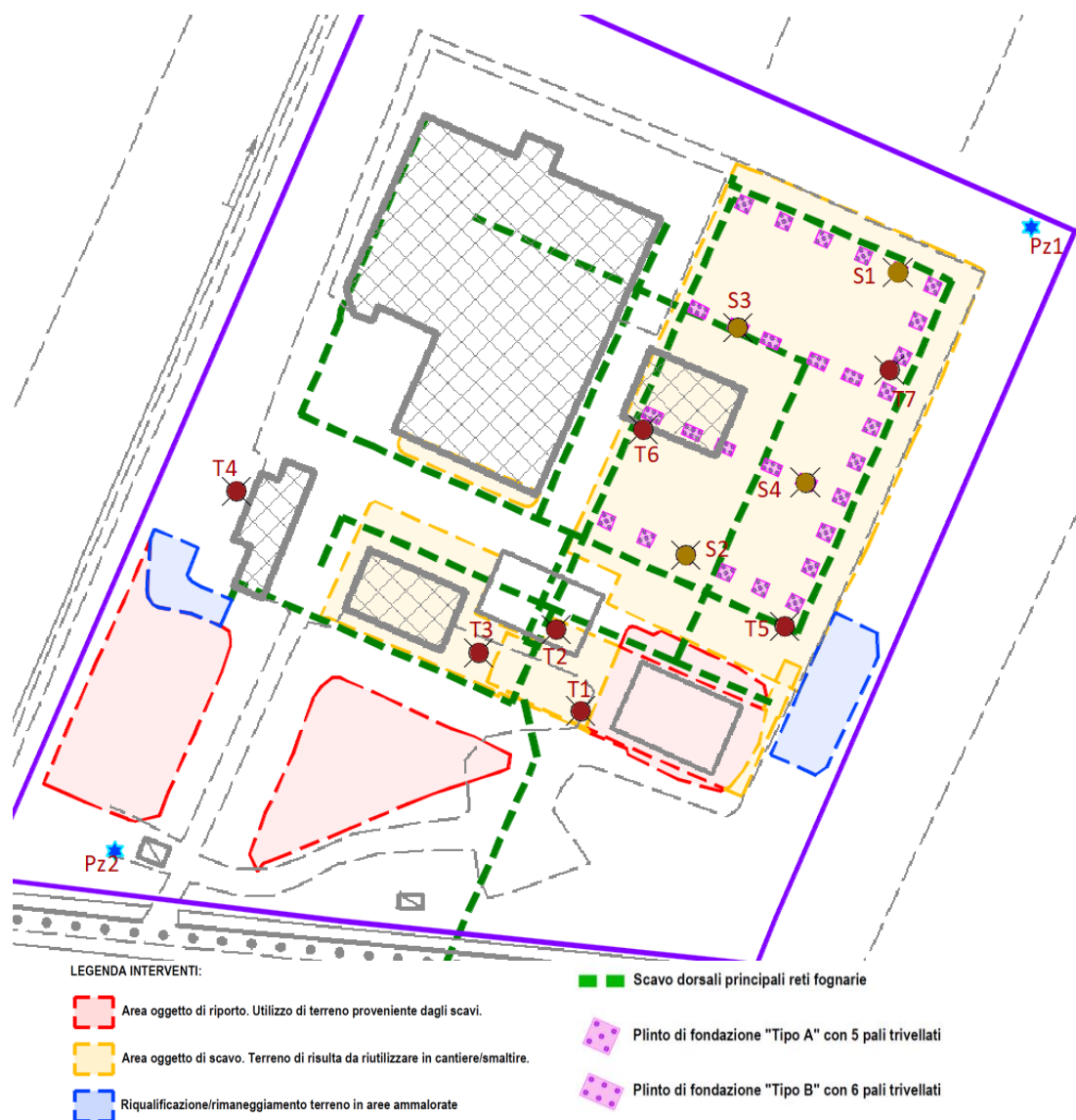
Figura 49. Ubicazione delle verticali di campionamento su base planimetria scavi-riporti.
