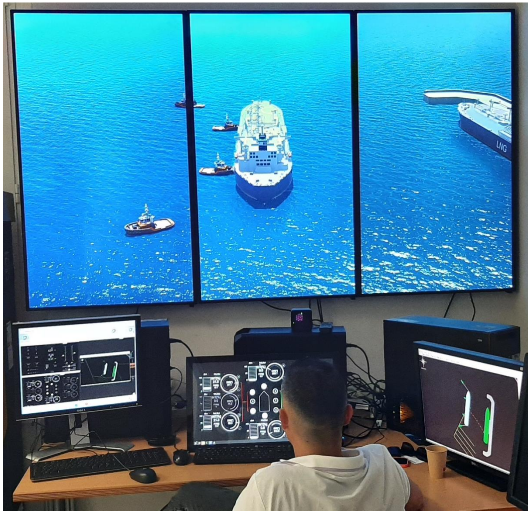
Fig. 4-1 Simulatore MANTA – Durante le prove i rimorchiatori sono stati comandati tramite un touch screen dedicato.
