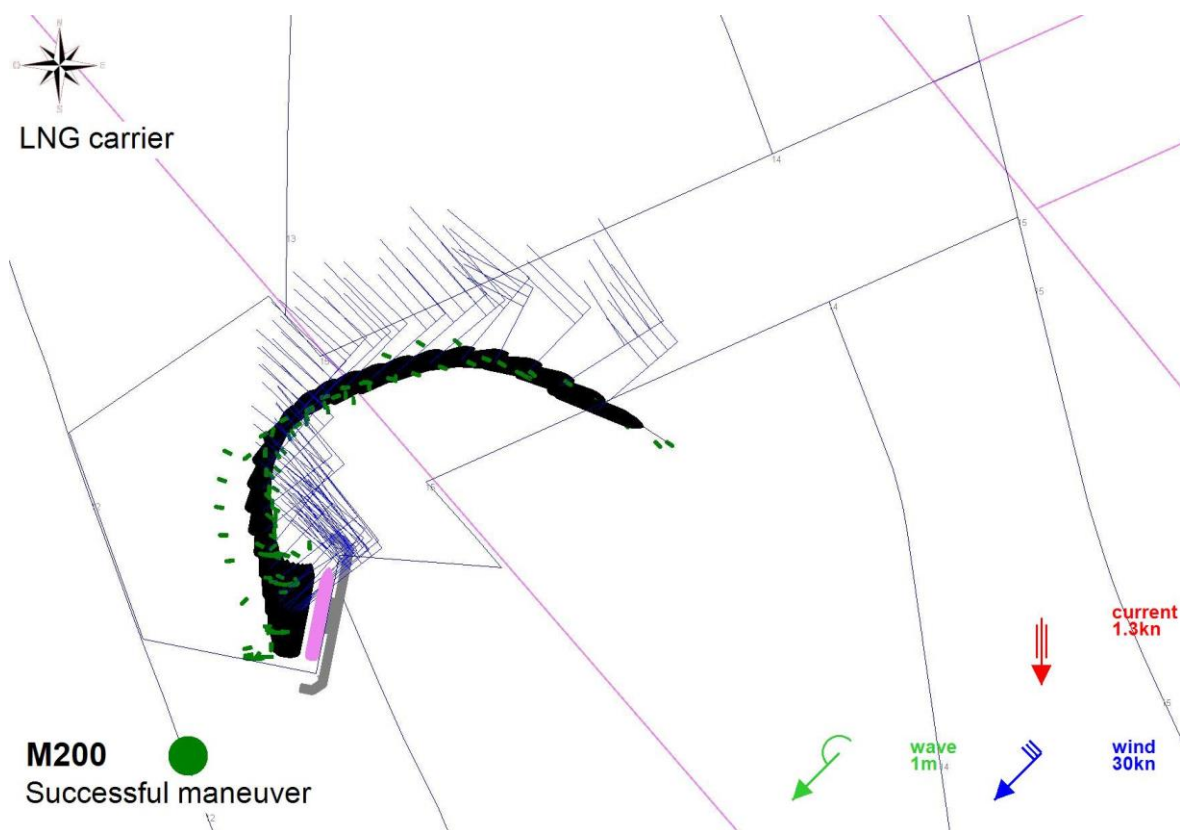
Fig. A - 22 – Manovra M200 – LNG Carrier - Uscita - MANOVRA RIUSCITA Grecale 30 nodi.
