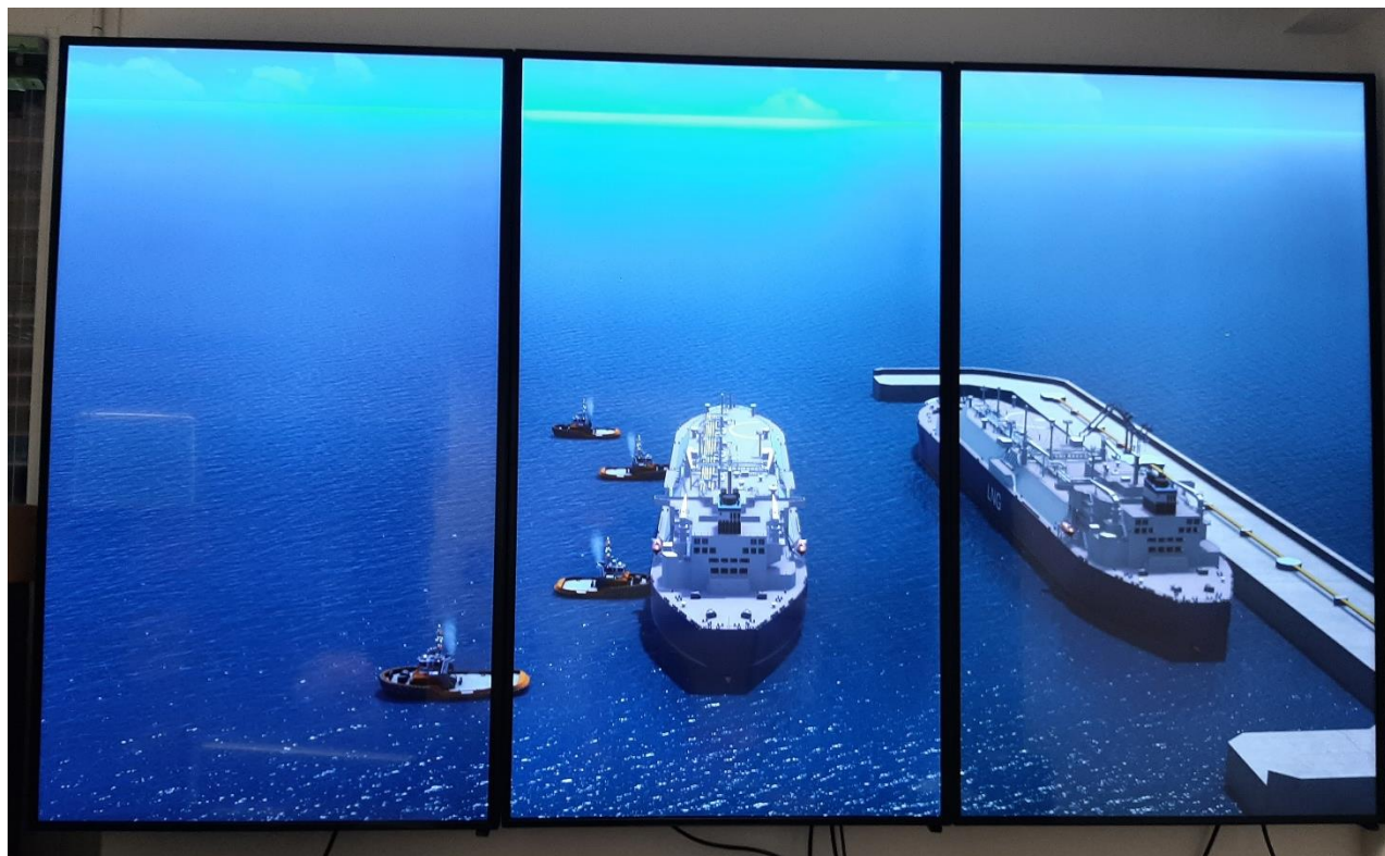
Fig. 4-2 Simulatore MANTA - Visualizzazione in tempo reale dei rimorchiatori impiegati durante il test.
