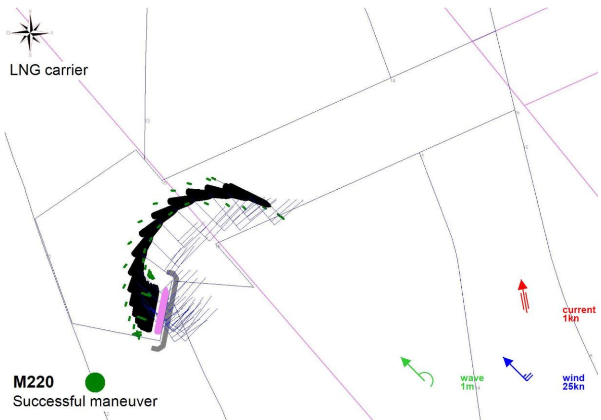
Fig. A - 24 – Manovra M220 – LNG Carrier - Uscita - MANOVRA RIUSCITA Sirocco 25 nodi.
