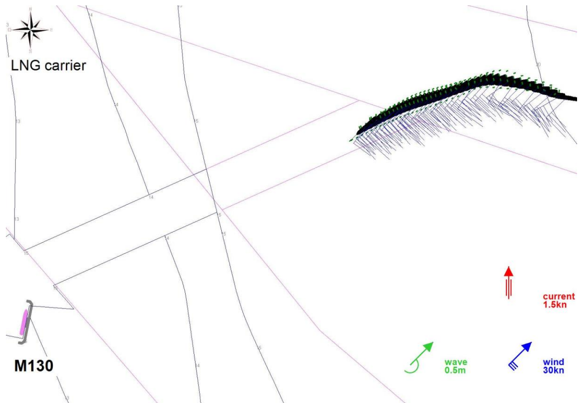
Fig. A - 15 – Manovra M130 – LNG Carrier - Ingresso - TEST
