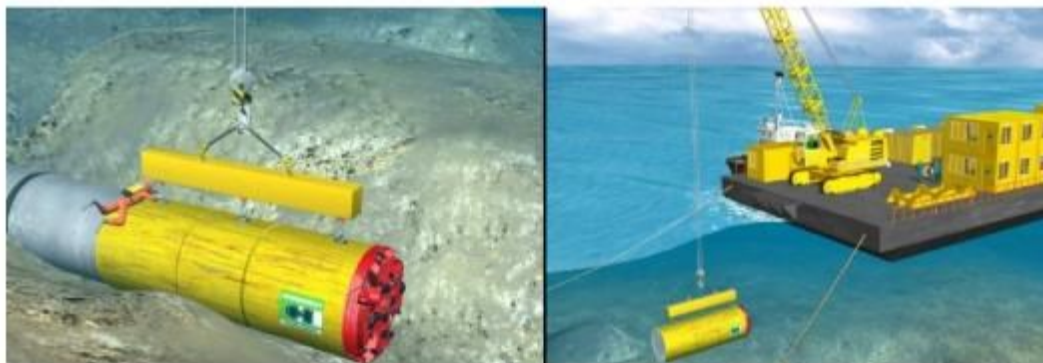
Figura 6-3 Recupero della fresa meccanica a mare
