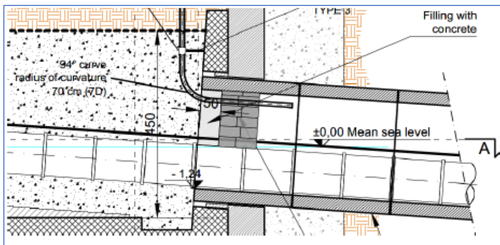
Figura 7-7 Esempio di tappo di chiusura del MT
