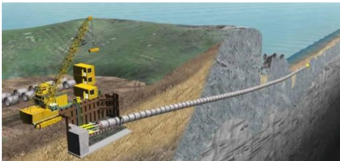
Figura 5-3 Fase di scavo del microtunnel con uscita in mare
