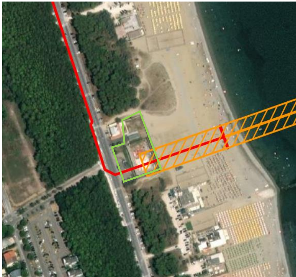
Figura 7.3: In verde l'area di lavoro per postazione di spinta microtunnel a Ravenna, in rosso il metanodotto in progetto
