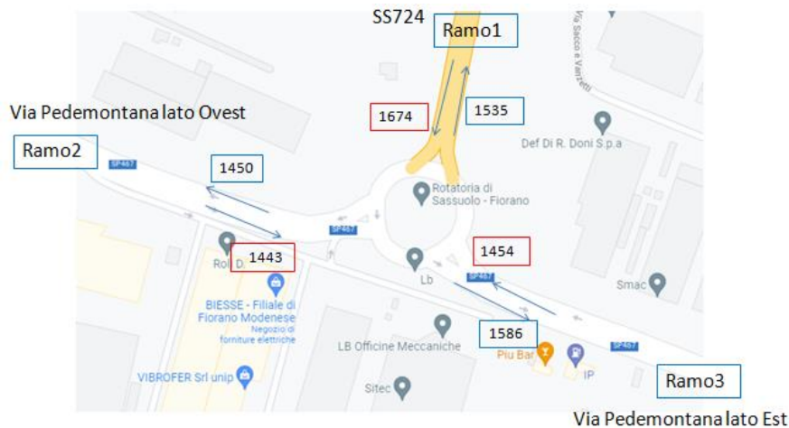
Flussi in ingresso ed in uscita sulla rotatoria via Pedemontana-SS724 nell'ora di picco mattutina 07.30-08.30 in veic eq./h- scenario LT senza flussi aggiuntivi - (tot. flussi circolanti: \approx 4.571 veic eq/h)- Fonte sfondo: Google Maps
