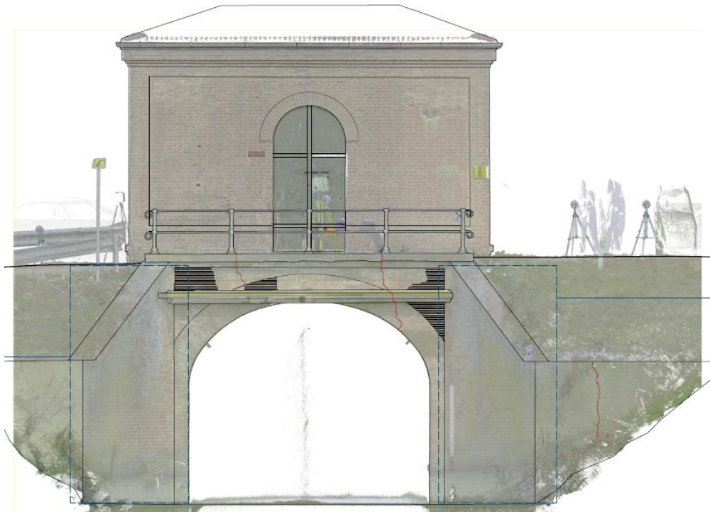
Figura 12 Estratto dalle tavole grafiche dello stato di fatto. Fronte sud della chiavica della "Cucca".
