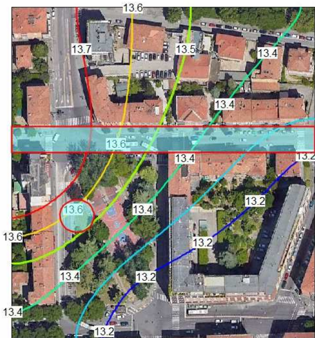
Figura 1-11 – Opere in progetto e modellazione del flusso sotterraneo (SUP2)
