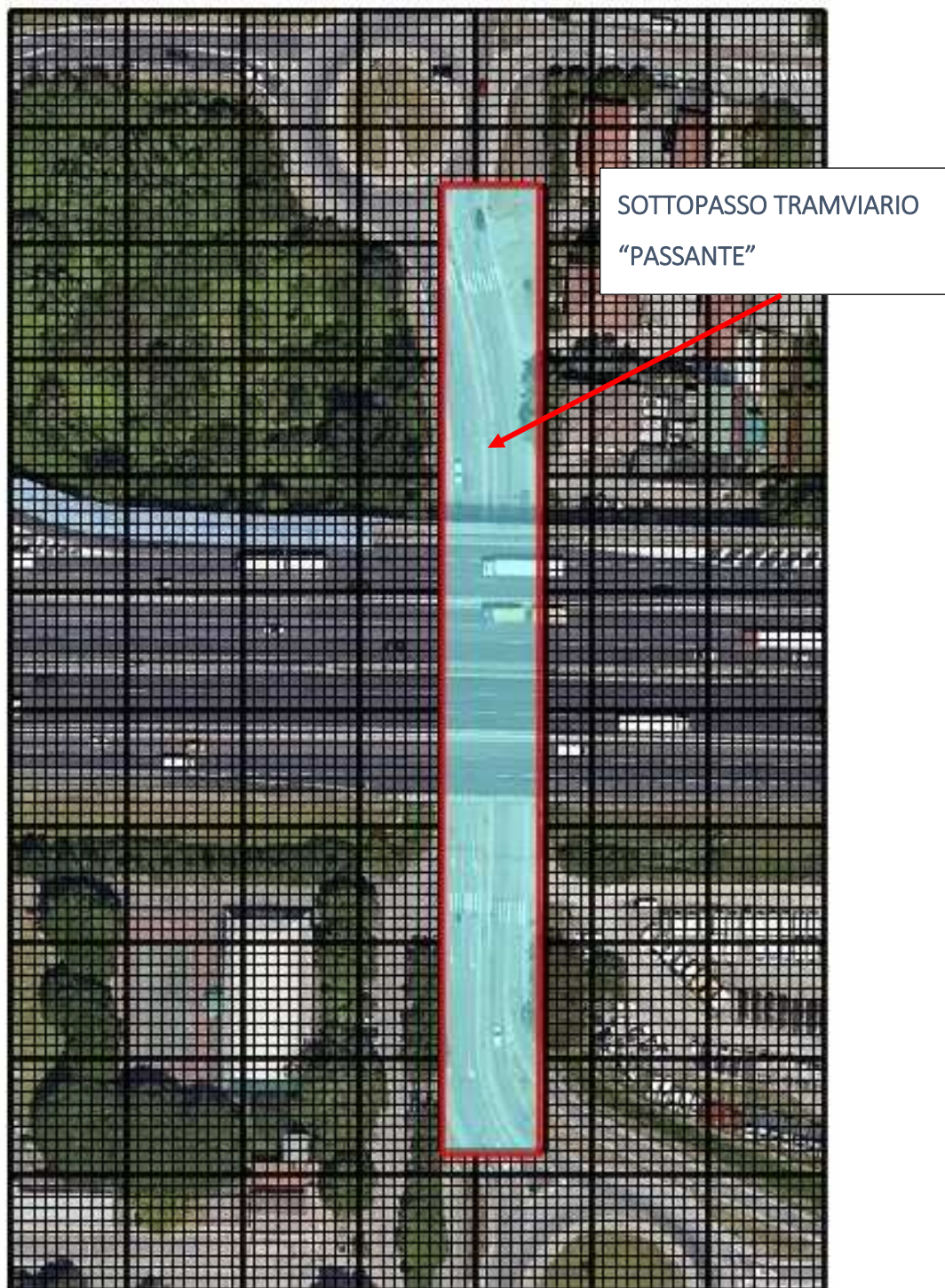
Figura 1-17 – Griglia di calcolo realizzata in ModelMuse per la modellazione numerica del flusso sotterraneo
