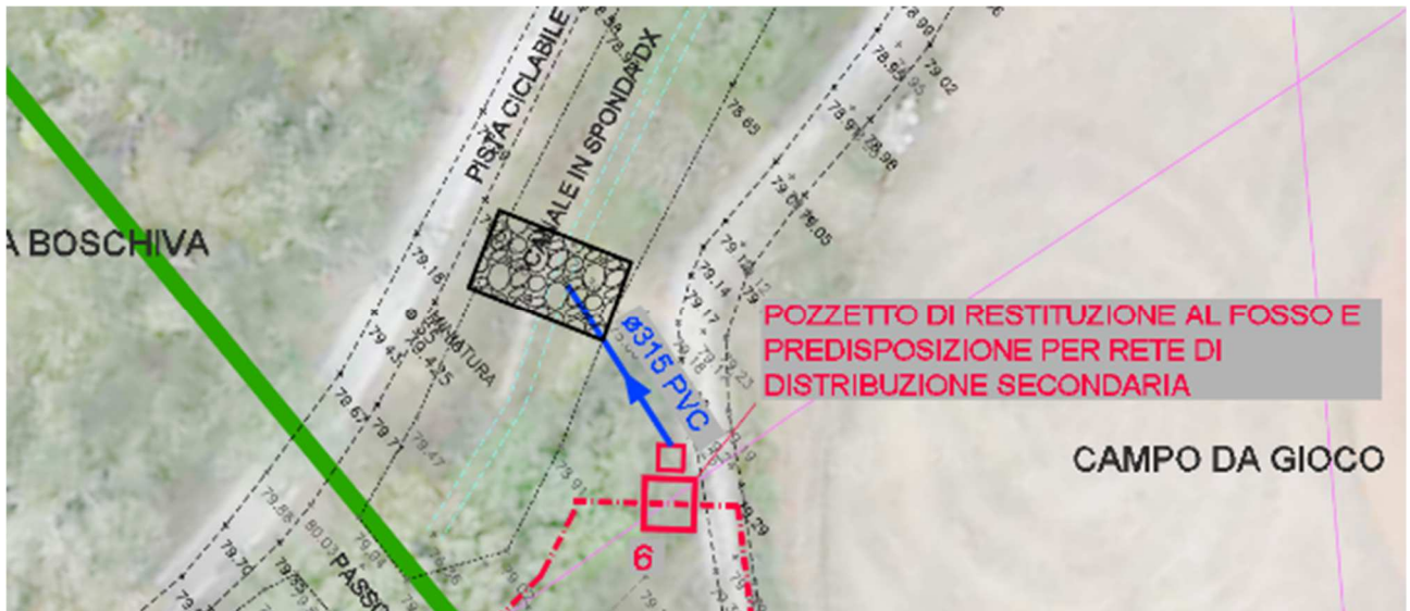
Figura 20: Esempio nodo di restituzione al canale Dx Marecchia e predisposizione per collegamento futura rete secondaria
