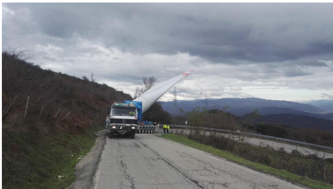
Fig. 8 : mezzo trasporto eccezionale speciale pala (blade lifter)
