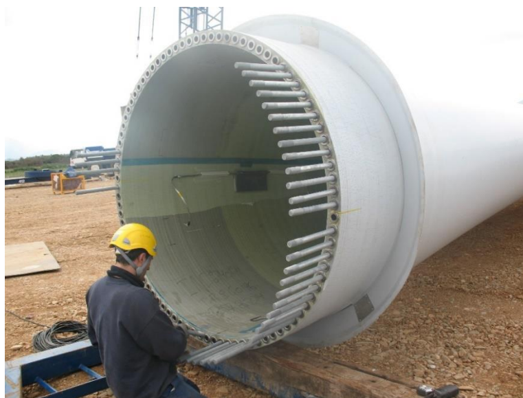
Fig. 6 : vista perni ancoraggio pala
