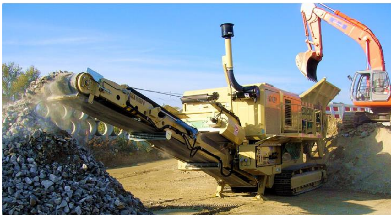
Figura 5.3 – Tipico frantoio mobile per il riutilizzo in sito delle rocce da scavo
