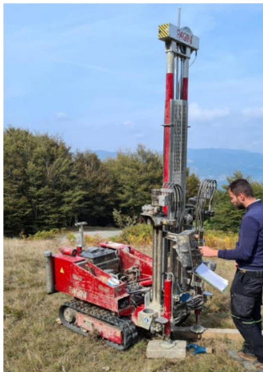
Figura 4-2 Sonda Pagani utilizzata per le prove DPSH
