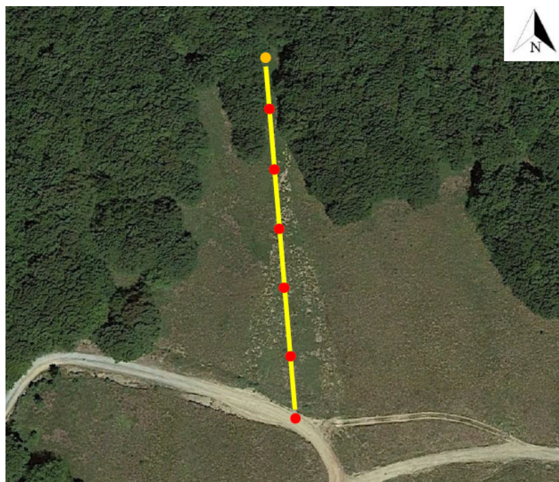
Figura 6.12 – Ubicazione in dettaglio della prima stesa, denominata “Tomografia Sismica L3”. La linea gialla mostra la geometria della stesa avente come estremi i geofoni 1 e 24, mentre i pallini rossi evidenziano i punti di energizzazione
