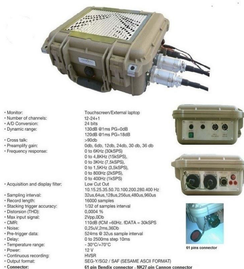
Figura 5.3 – sismografo utilizzato per le tomografie
