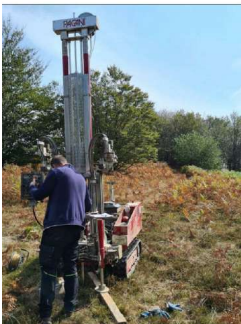
Figura 5.32 – foto del piazzamento prova DPSH04, dati acquisiti ed elaborati e schema grafico AEROGENERATORE BT02 – prova DPSH02
