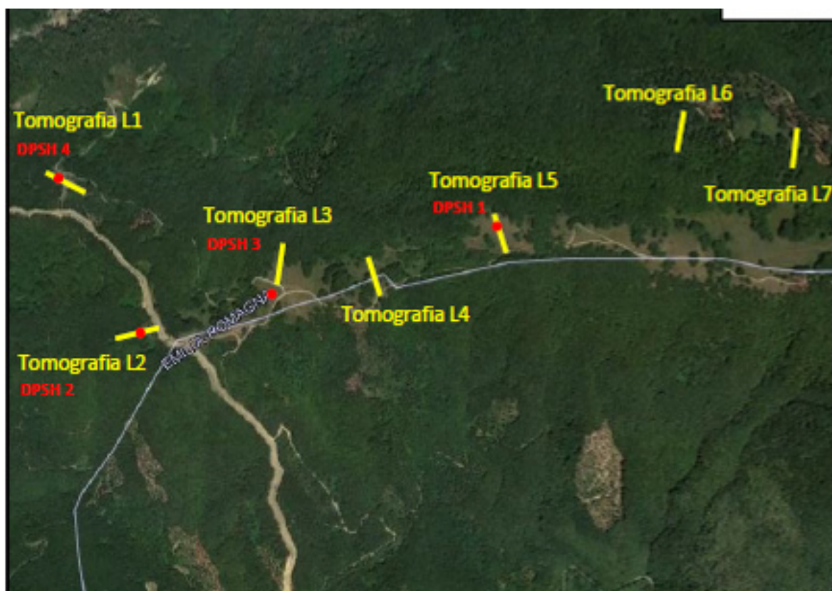
Figura 5.1 – planimetria delle indagini geognostiche
