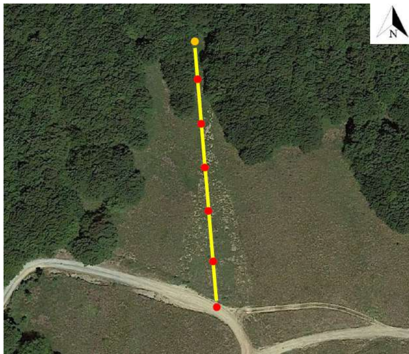
Figura 5.42 – Ubicazione in dettaglio della prima stesa, denominata “Tomografia Sismica L3”. La linea gialla mostra la geometria della stesa avente come estremi i geofoni 1 e 24, mentre i pallini rossi evidenziano i punti di energizzazione
