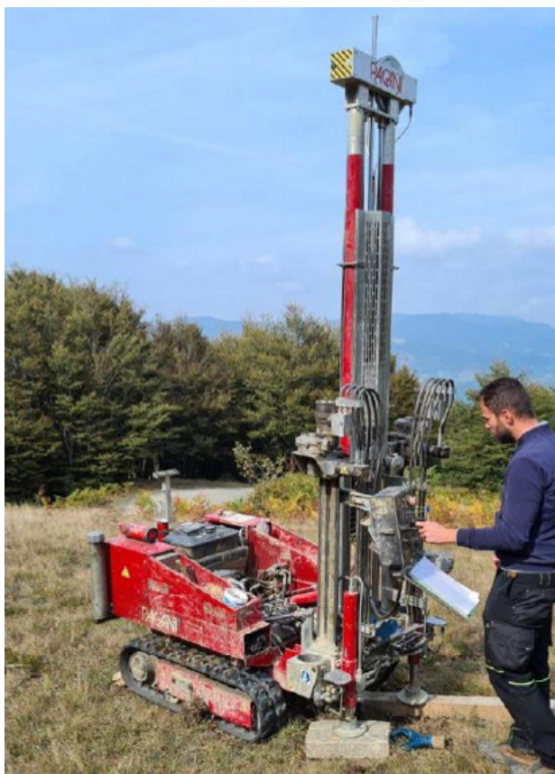
Figura 5.2 – sonda Pagani utilizzata per le prove DPSH
