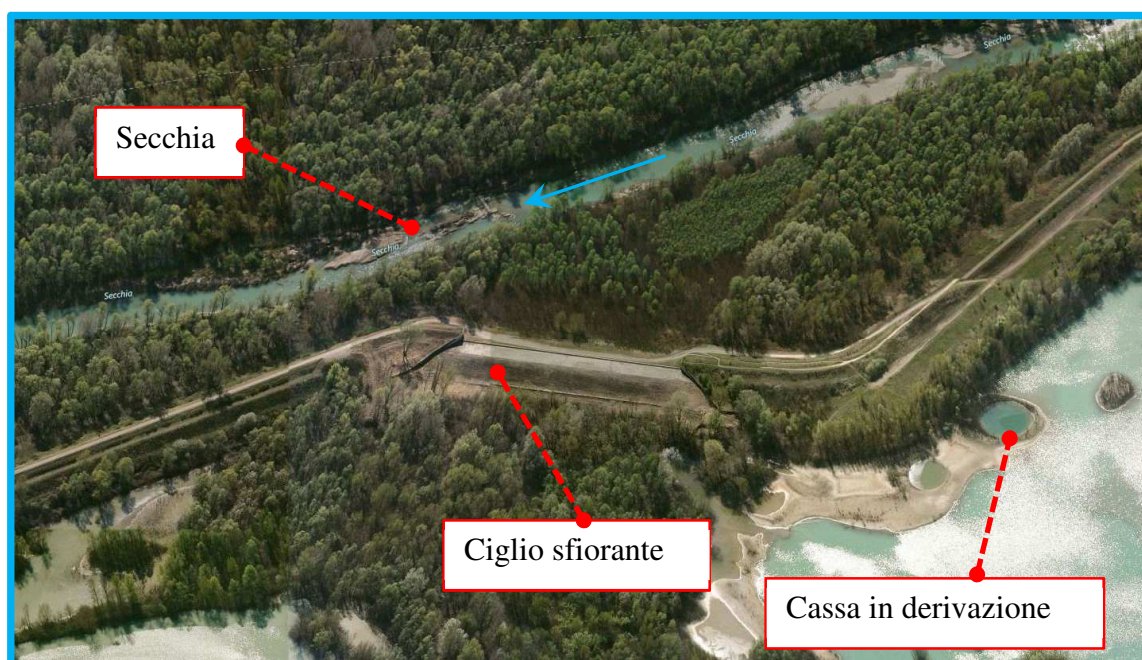
Figura 2.7: Area della cassa di espansione di Rubiera: manufatto di immissione nell'invaso laterale.
