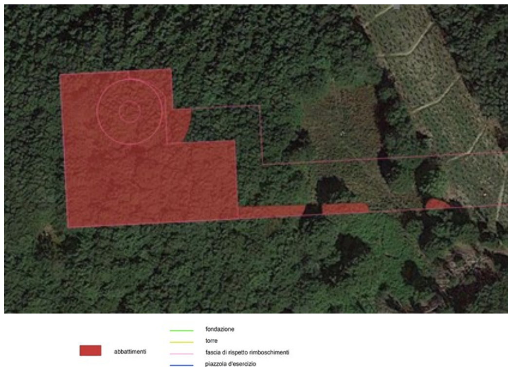
Figura 4-4 Abbattimenti per la realizzazione della piazzola dell'aerogeneratore BT01
