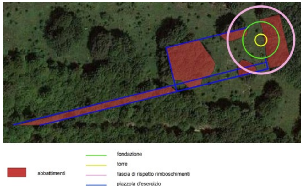
Figura 4-10 Abbattimenti per la realizzazione della piazzola dell'aerogeneratore BT07
