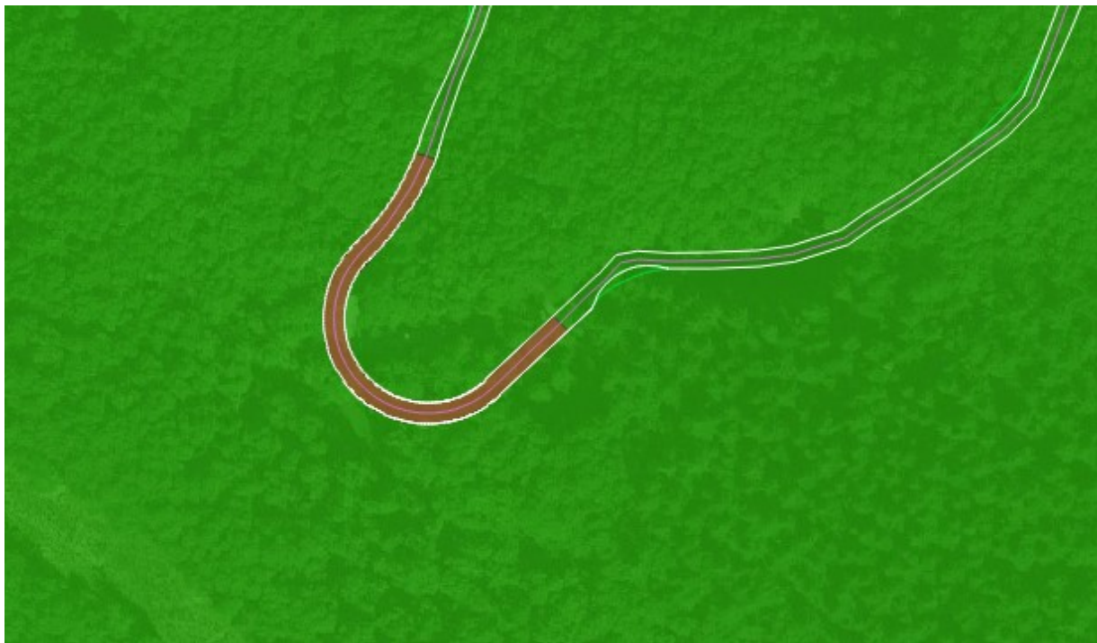
Figura 4-2 allargamento tornante dopo Case Vighini (in rosso abbattimenti)
