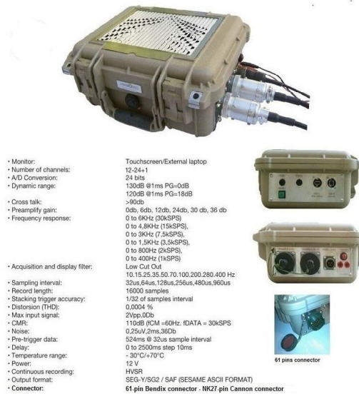
Figura 6.2 – sismografo utilizzato per le tomografie
