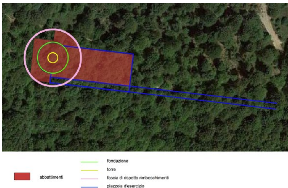
Figura 4-9 Abbattimenti per la realizzazione della piazzola dell'aerogeneratore BT06
