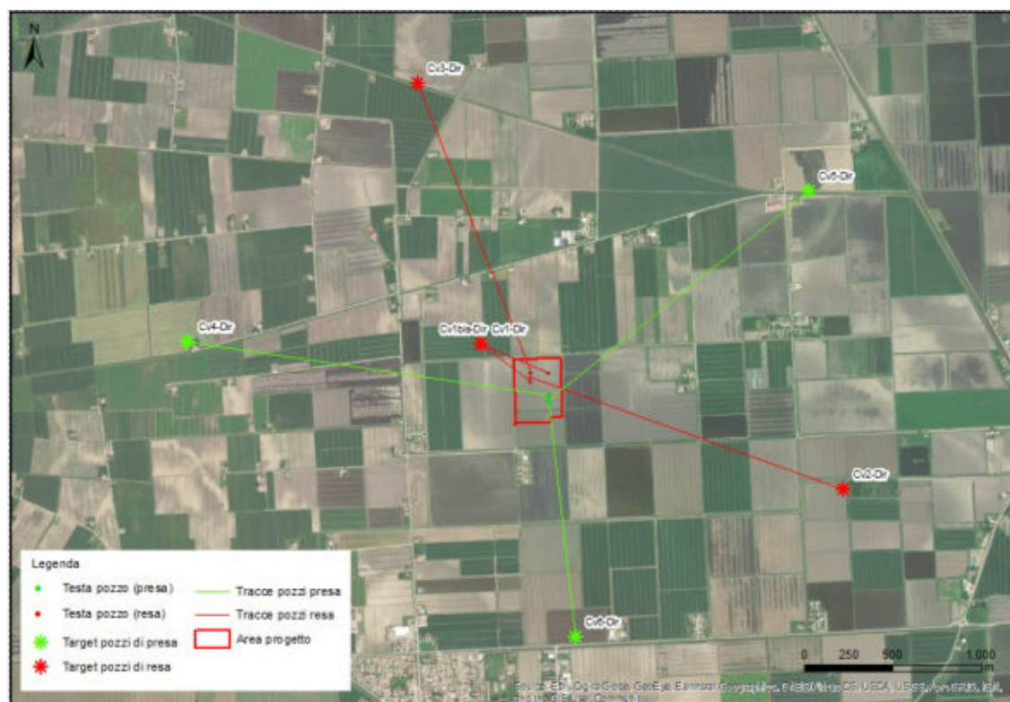
Figura 8. Ubicazione dei pozzi in progetto e proiezione in superficie della deviazione in profondità
